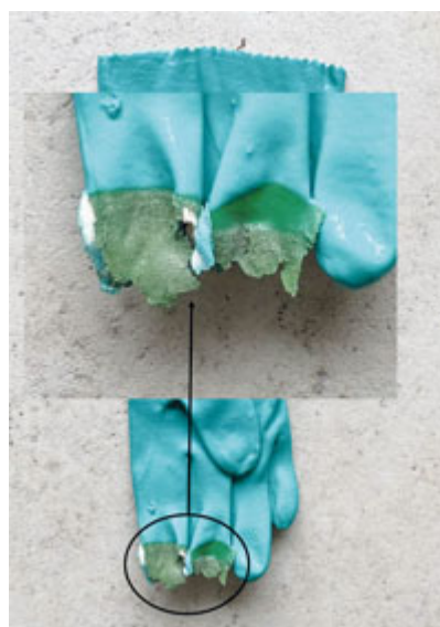
Abbildung 9-3: Degradation eines beschichteten Chemikalienschutzhandschuhs aus Nitril in Folge einer mehrminütigen Einwirkung durch Schwefelsäure
