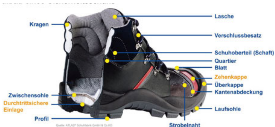
Abbildung 10-13: Beispielhafter Aufbau eines Sicherheitsschuhs der Klasse I
