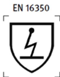
Abbildung 9-9: Piktogramm für Schutzhandschuhe mit elektrostatischen Eigenschaften
