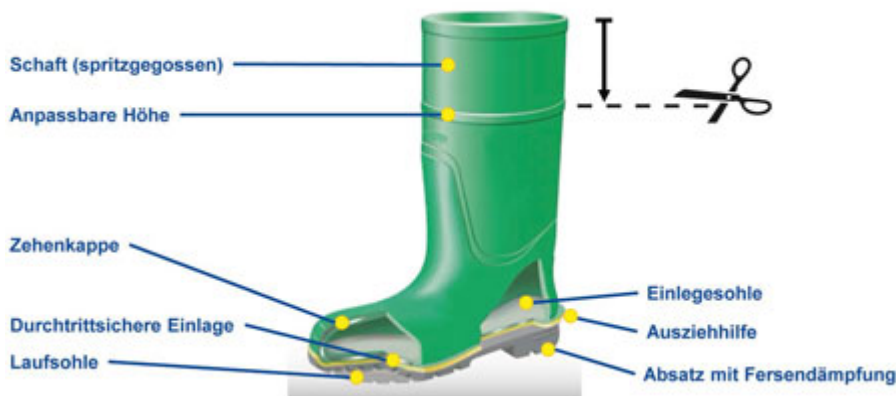
Abbildung 10-14: Beispielhafter Aufbau eines Sicherheitsschuhs der Klasse II
