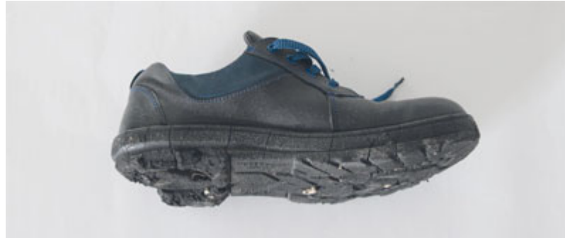
Abbildung 10-16: Sicherheitsschuh mit abgelöster Polyurethansohle
