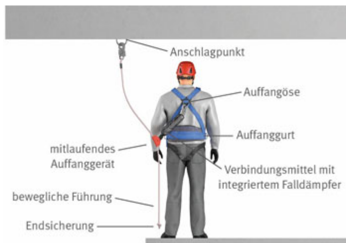
Abbildung 11-3: Auffangsystem mit Verbindungsmittel und Falldämpfer
