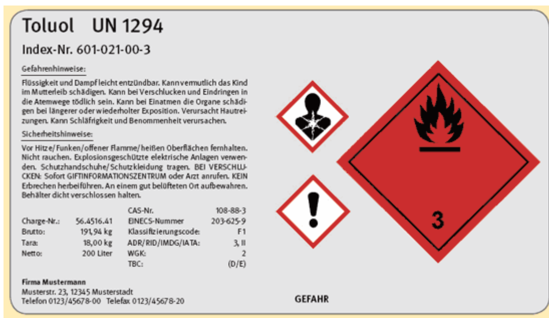
Abbildung 4c: Einzelverpackung: Etikett mit integriertem Gefahrzettel für Toluol
