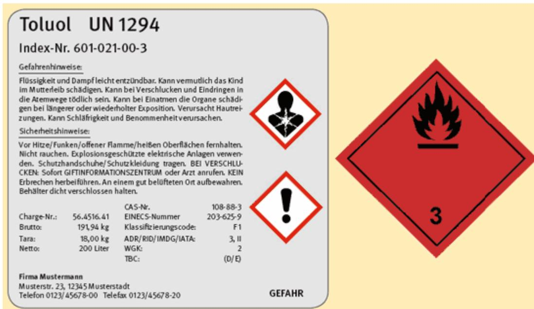
Abbildung 4c: Einzelverpackung: Etikett mit integriertem Gefahrzettel für Toluol
