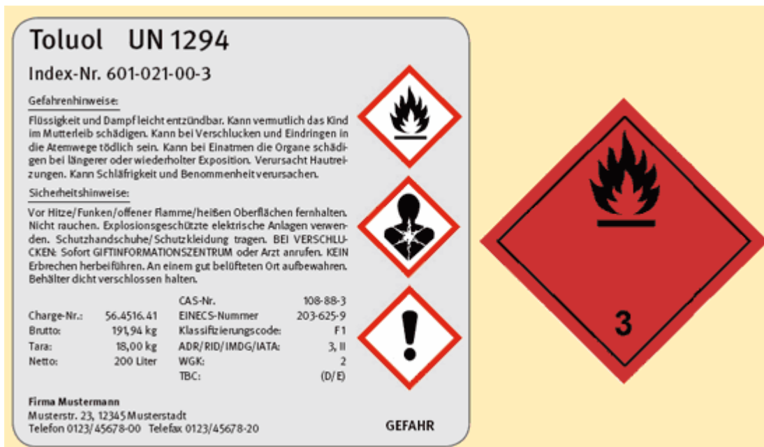
Abbildung 4b: Einzelverpackung: Reduziertes Etikett und Gefahrzettel für Toluol
