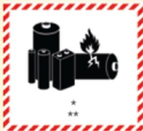
Abbildung 13: Kennzeichen für Lithiumbatterien nach 5.2.1.9.2 ADR mit Platz für die UN-Nummer(n) „\*“
