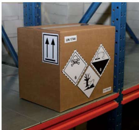
Abbildung 3b: Außenverpackung einer zusammengesetzten Verpackung: Vollständiges Etikett und Gefahrgutkennzeichnung von Brom
