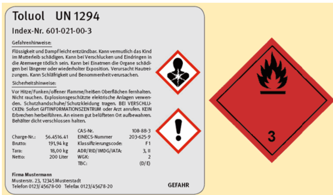
Abbildung 4b: Einzelverpackung: Reduziertes Etikett und Gefahrzettel für Toluol
