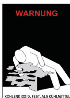
Abbildung 15: Warnkennzeichen bei der Verwendung von Trockeneis als Kühlmittel
