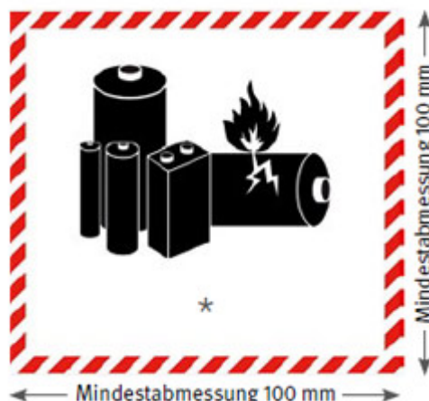
Abbildung 23: Kennzeichen für Lithiumbatterien nach 5.2.1.9.2 ADR mit Platz für die UN-Nummer(n) „*“
