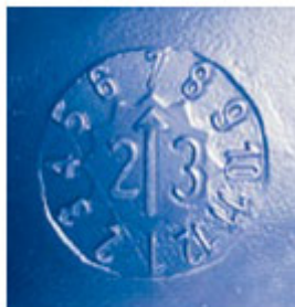
Abbildung 7: „Kunststoffuhr“: Kennzeichnung mit dem Herstellungsdatum (Monat und Jahr)
