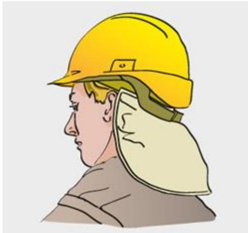
Abbildung 20: Krempe zum Überziehen auf Schutzhelm mit Nackenschutz
