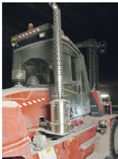
Abbildung 31: Dieselpartikelfilter am Fahrzeug – leicht zugänglich für Wartungsarbeiten
