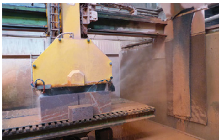
Abbildung 18: Nasssägen, der Wasserstrahl wird durch eine Spritzschutzmatte an der Wand gebremst
