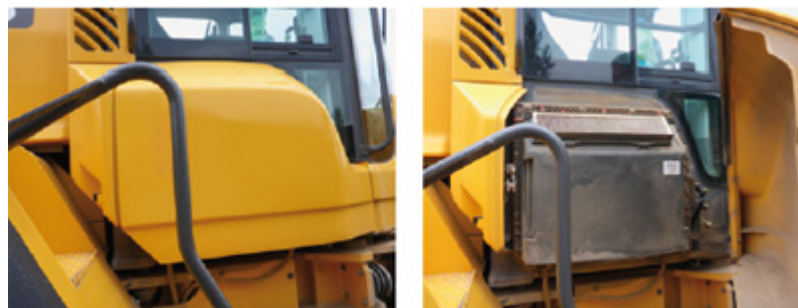
Abbildungen 27 und 28: Staubfilter an einer Radladerkabine
