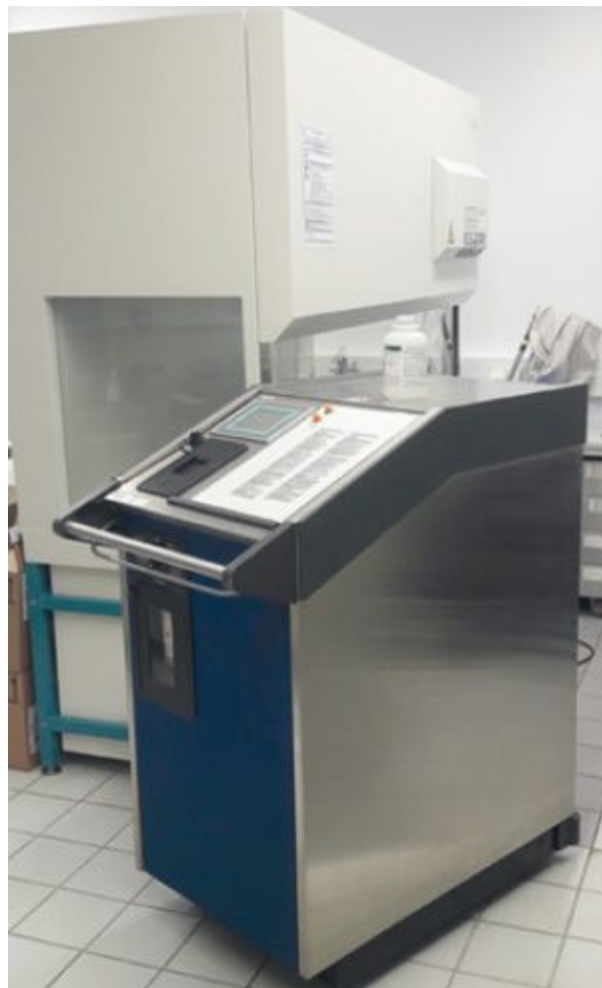
Abbildung 55: Vorbereitende Arbeiten zur Begasung einer MSW mit einem H_2O_2 -Generator
