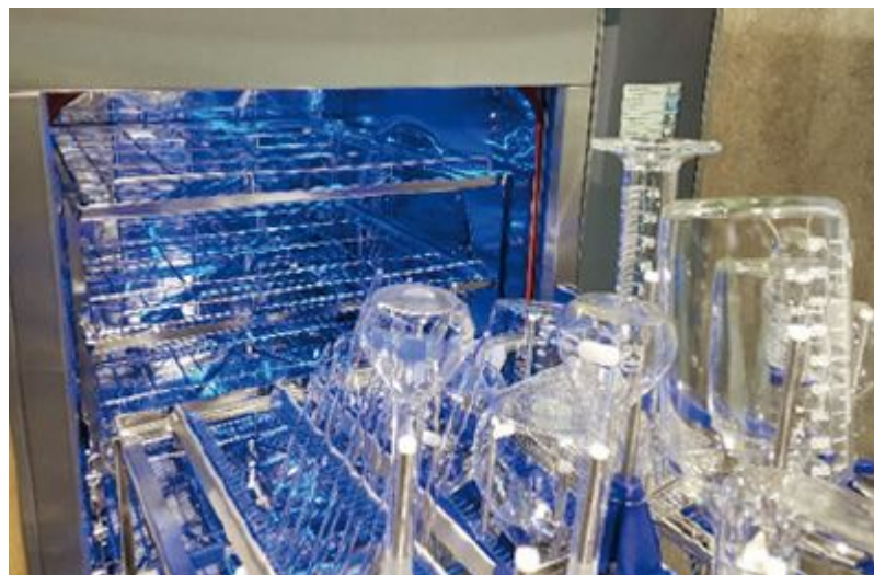
Abbildung 52: Laborspülautomat zur Reinigung und Desinfektion
