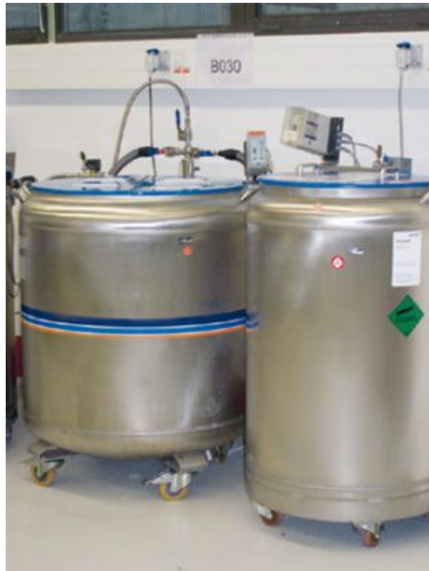
Abbildung 22: Flüssigstickstoff-Lagerbehälter mit Auffüllautomatik
