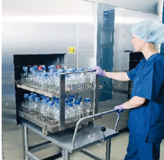
Abbildung 18: Vorbereitung zur Dampfsterilisation von Flüssigkeiten in ISO Flaschen
