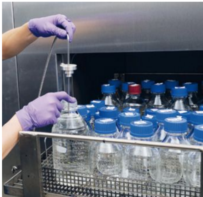
Abbildung 19: Referenzflasche mit Thermofühler PT 100 für die Programmsteuerung bei Flüssigkeiten
