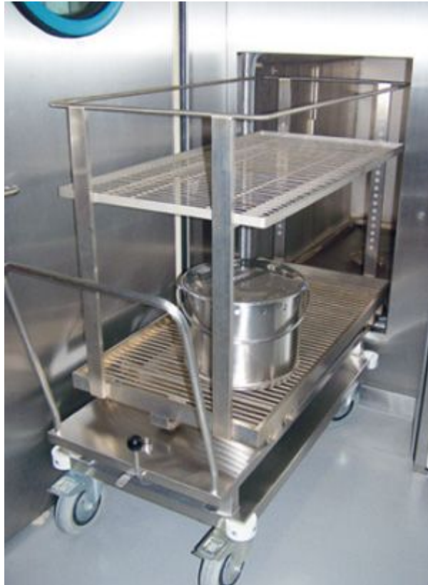
Abbildung 16: Ladewagen mit Einschub und Autoklaviertrommel vor einem Durchreicheautoklaven
