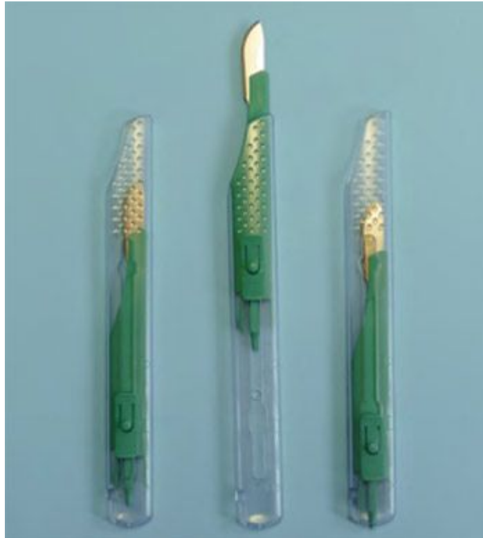
Abbildung 23: Sicherheitsskalpell zum einmaligen Gebrauch (von links nach rechts: Lieferzustand mit, geschützt in der Hülle, eingerasteter Klinge – Arbeitsstellung mit offener, eingerasteter Klinge – Entsorgungsstellung mit irreversibel in der Schutzhülle eingerasteter Klinge)
