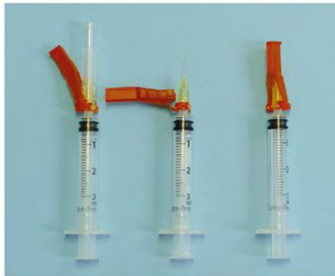
Abbildung 22: Sicherheitskanüle (von links nach rechts: Anlieferungszustand, aufgesteckt auf die Spritze – Arbeitsstellung mit ungeschützter Nadel – Entsorgungsstellung mit arretiertem Nadelschutz)
