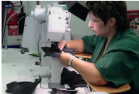
**Abb. 15c:** Körperhaltung bei abgestützten Armen an einer Säulennähmaschine
