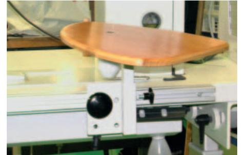
**Abb. 15d:** Detailbild, verstellbare Armauflage
