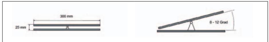
**Abb. 16:** Skizzen von Fußschaltern: (links) waagerechter Wippschalter für stehende oder kombinierte Arbeitsplätze (rechts) geneigtes Pedal für sitzende Tätigkeit
