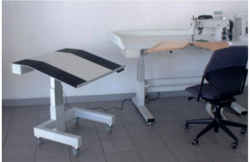
Abb. 22: Höhenanpassbare Materialbereitstellung
