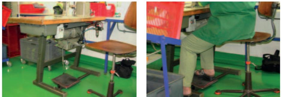
**Abb. 7a und b:** Negativbeispiele mit Einengung des Beinraumes unter dem Tisch durch Einbauten
