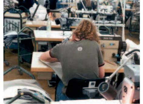
**Abb. 7c, d und e:** Negativbeispiele – Aufnahmen von Näherinnen: stark vorgebeugte bzw. gekrümmte und verdrehte Haltung des Oberkörpers, da die Tischhöhe zu niedrig und die Fußschalter nicht weit genug nach vorne unter dem Tisch angebracht sind.
