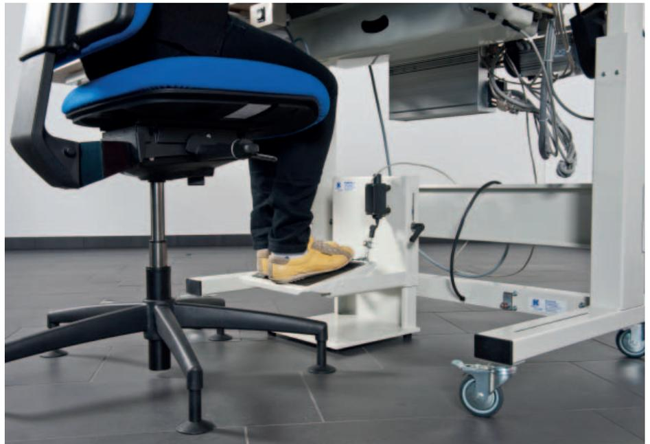
**Abb. 9:** Freier Beinraum: Alle störenden Maschinenelemente wurden nach außen verlegt.
