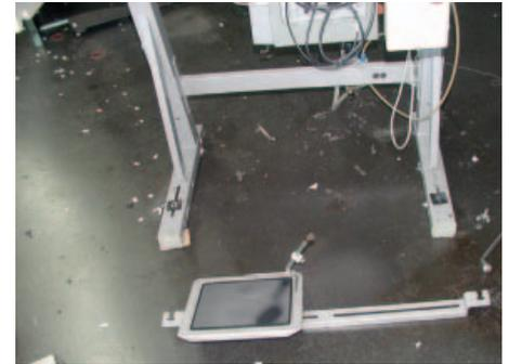
Abb. 25: Fußschalter ausgebaut
