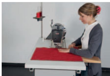
**Abb. 14:** Armauflagen an einer Flachbett Nähmaschine
