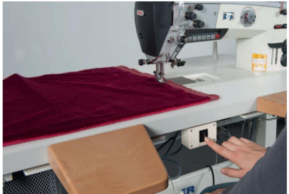
**Abb. 2b:** Bedienelemente der elektromechanischen Höhenverstellung
