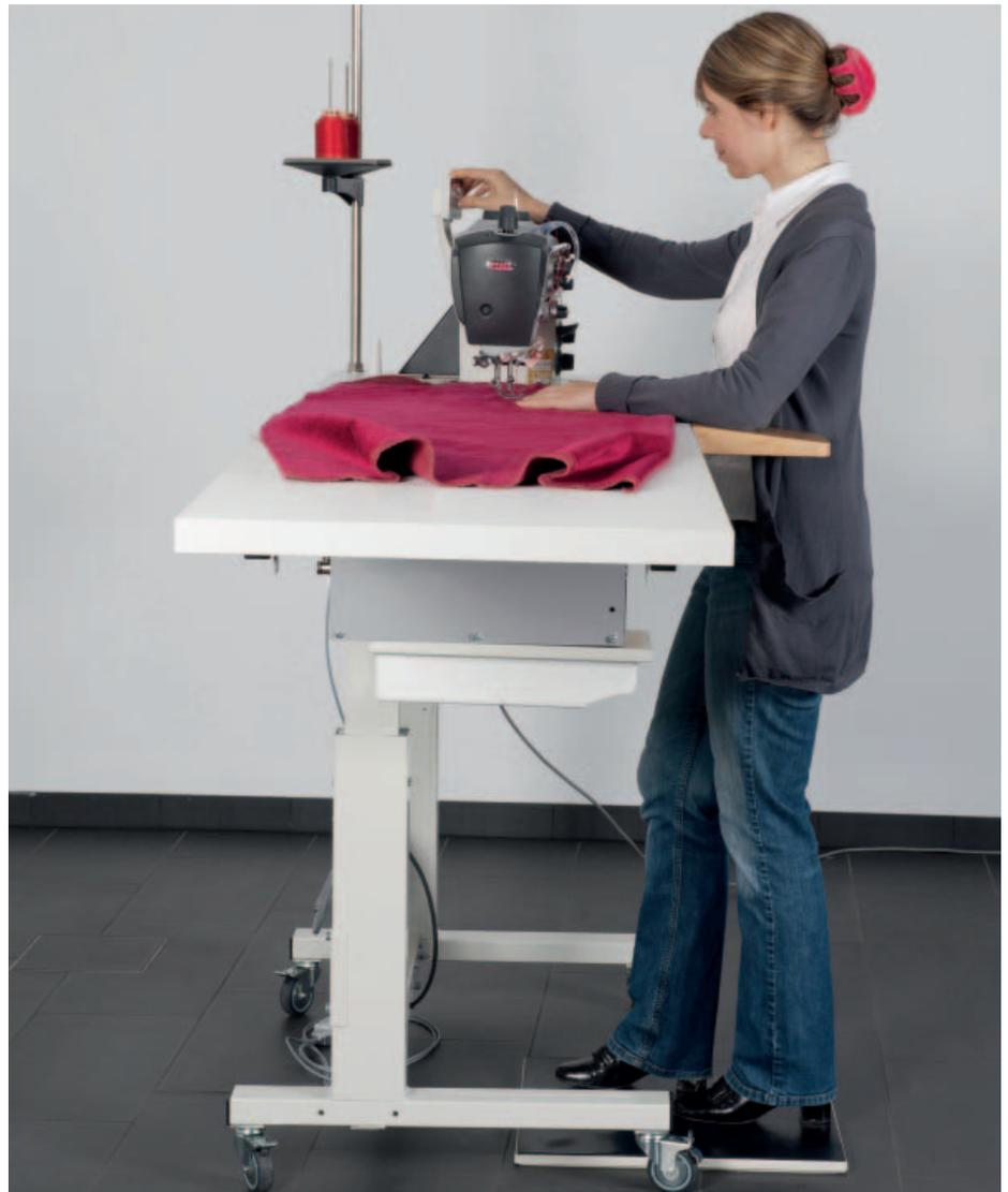
**Abb. 19a:** Sensormatte zur Fußbetätigung
