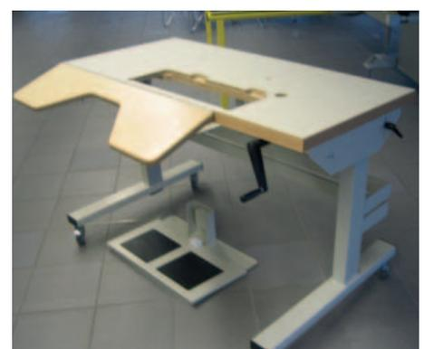
**Abb. 2c:** Nähmaschinengestelle mit Höhenverstellmöglichkeit mittels Handkurbel
