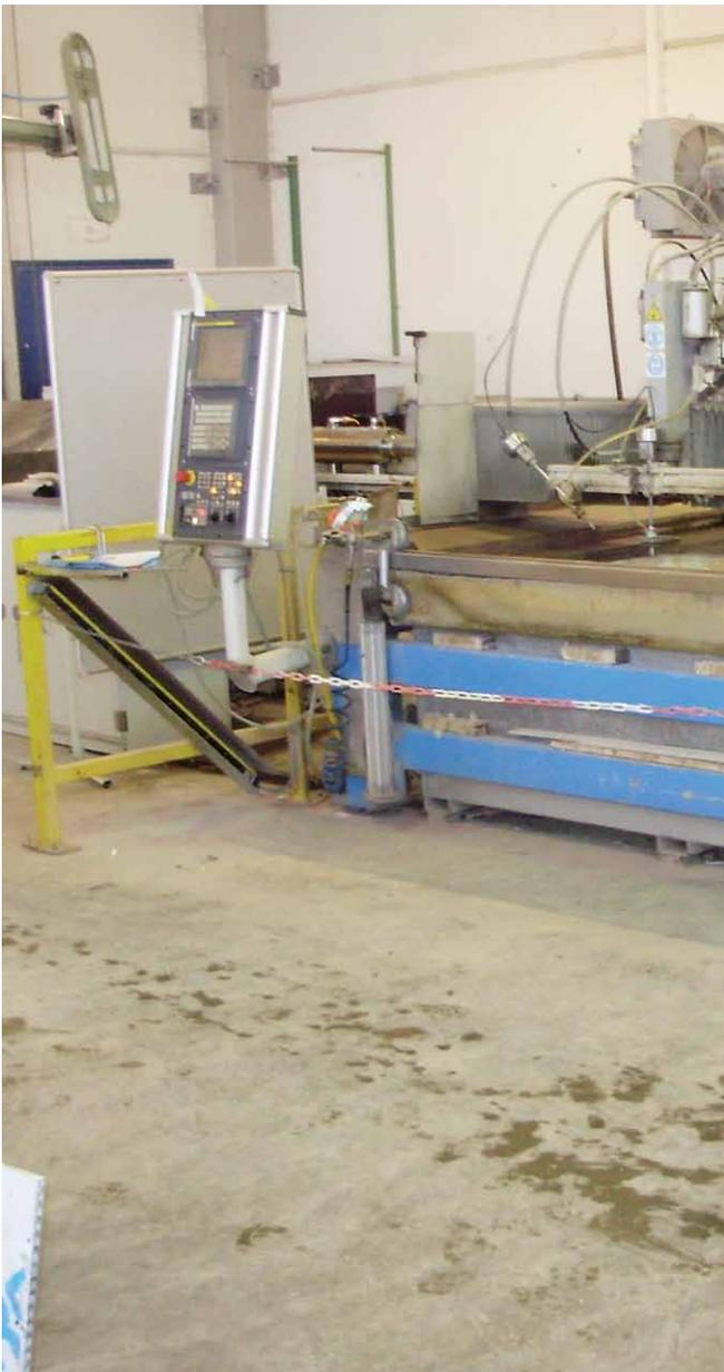
Abb. 8: Absicherung des Gefahrenbereiches durch Lichtschranke, die rot-weiße Kette soll das unbeabsichtigte Auslösen der Lichtschranke verhindern
