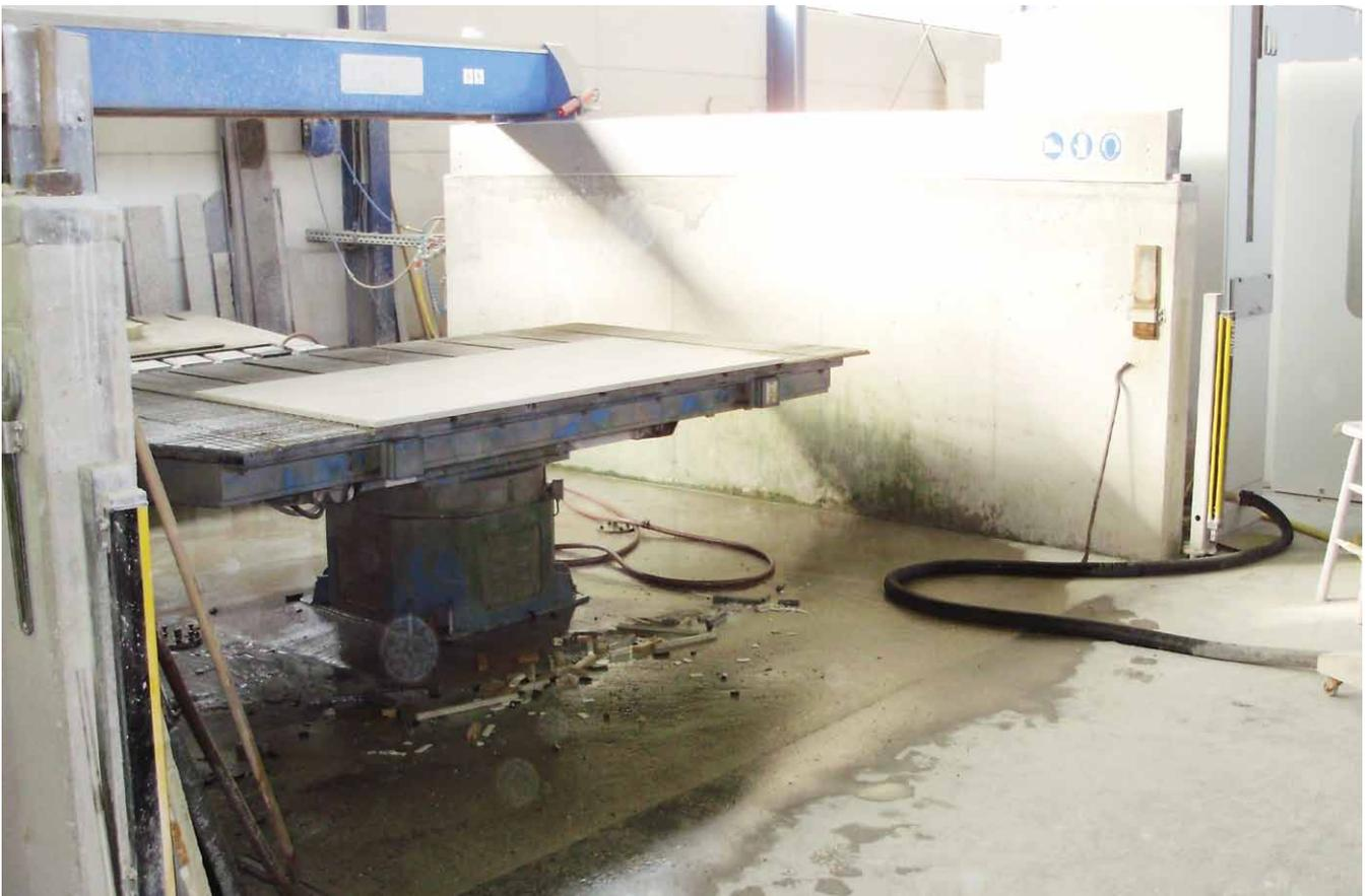
Abb. 10: Bereichssicherung durch eine Lichtschranke
