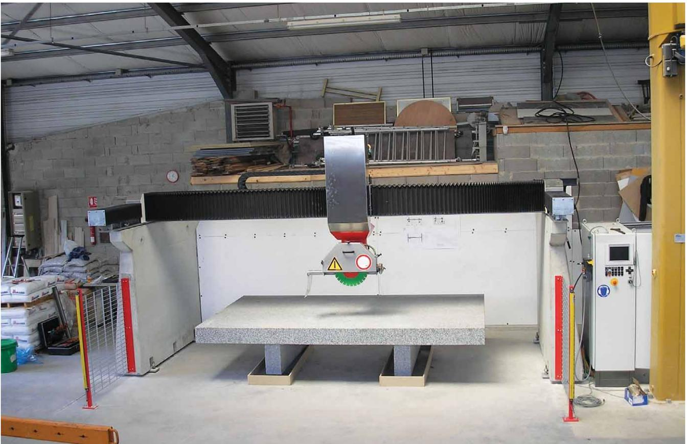
Abb. 1: Steinkreissägen mit Bereichssicherung
