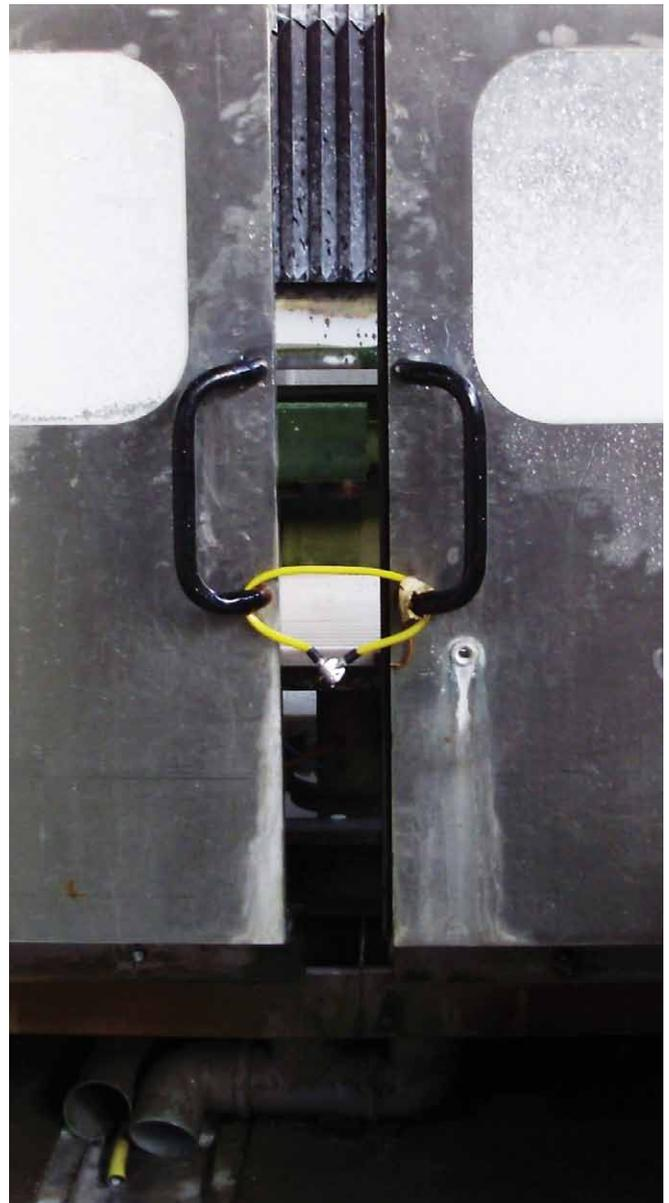
Abb. 13: Sicherung des Gefahrenbereiches durch ein Schloss
