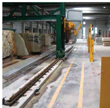
Abb. 4: Blockkreissäge mit drei durch Lichtschranken abgesicherten Arbeitsbereichen
