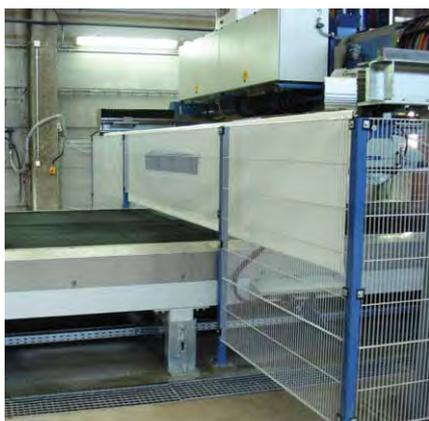
Abb. 2: Automatische Steinsäge mit Bereichssicherung
