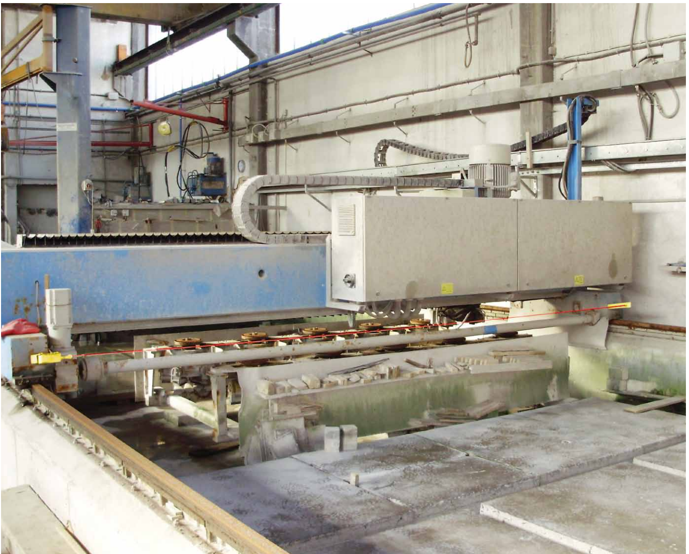
Abb. 16: Flächenschleifautomat mit Reißleinenschalter
