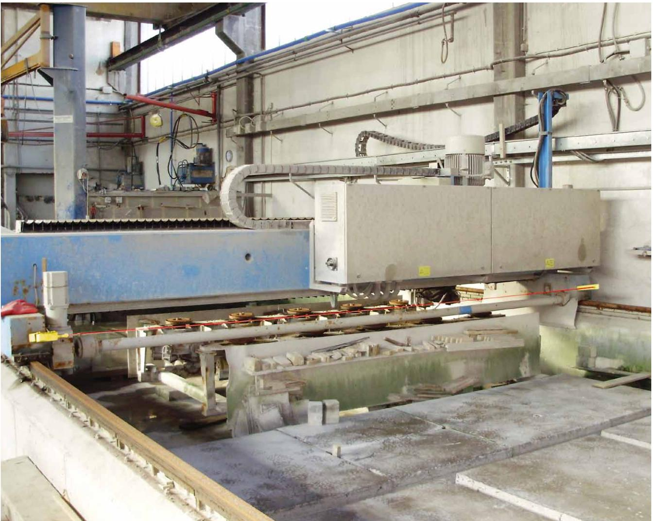
Abb. 16: Flächenschleifautomat mit Reißleinenschalter
