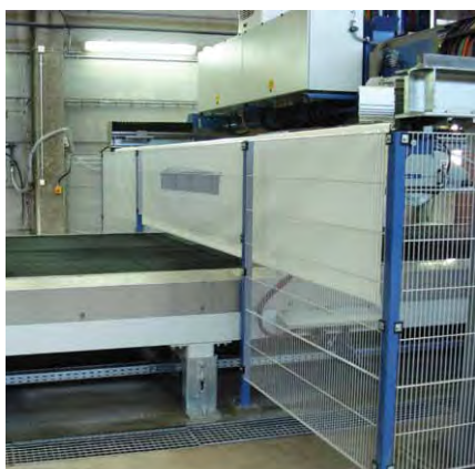
Abb. 2: Automatische Steinsäge mit Bereichssicherung
