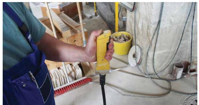
Abb. 18: Bereichsgesicherte Seilsäge mit Zustimmungsschalter
