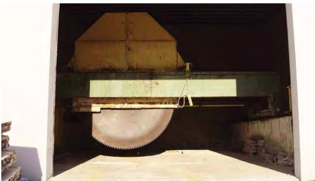
Abb. 15: Nur eine Anlage (Blocksäge) in der Halle
