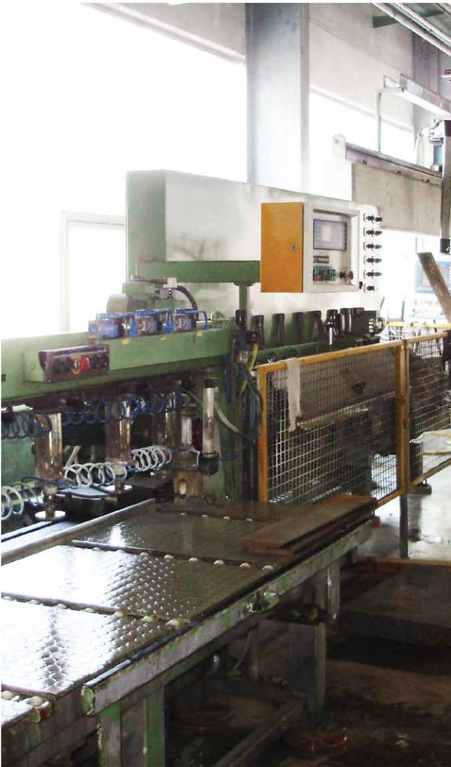
Abb. 6: Absicherung der Quetschstelle durch ein fest angebrachtes Gitter
