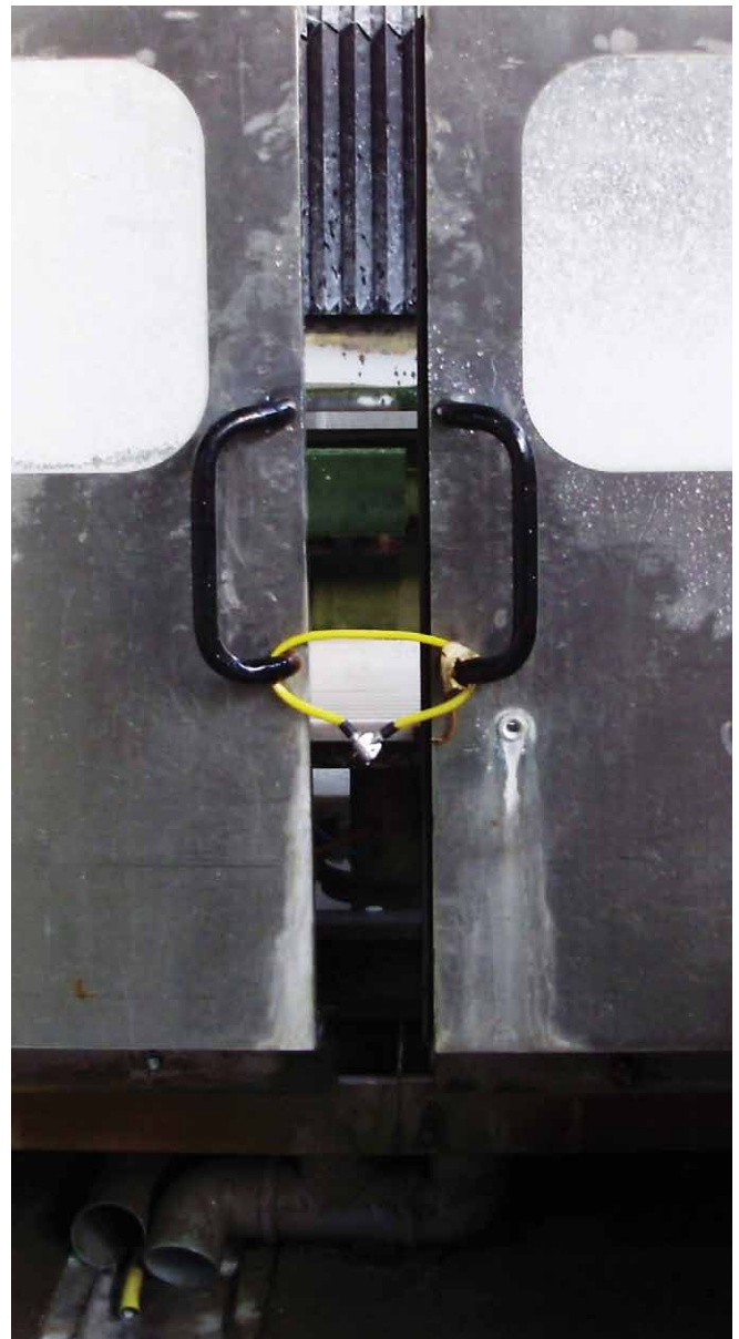
Abb. 13: Sicherung des Gefahrenbereiches durch ein Schloss
