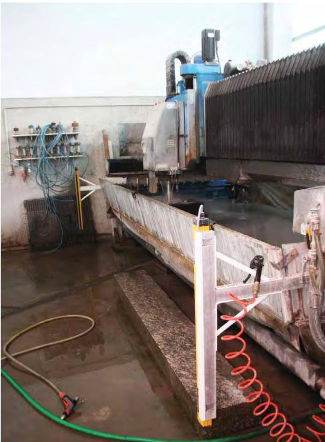
Abb. 12: Absicherung mit einer Lichtschranke
