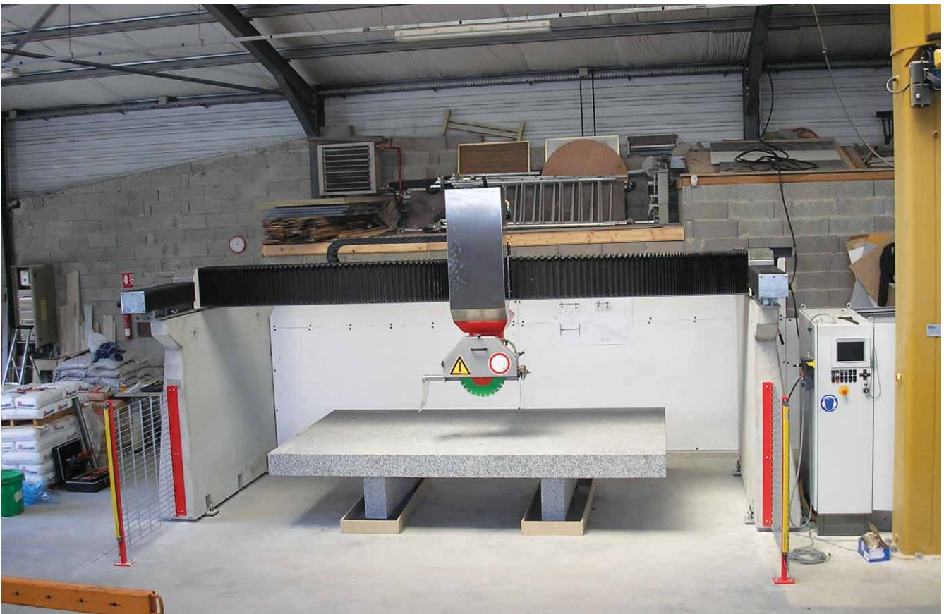
Abb. 1: Steinkreissägen mit Bereichssicherung
