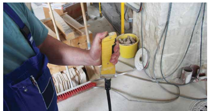
Abb. 18: Bereichsgesicherte Seilsäge mit Zustimmungsschalter
