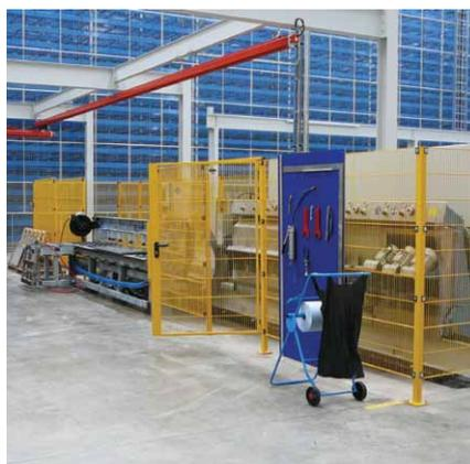
Abb. 3 : Kantenschleifer mit Bereichssicherung
