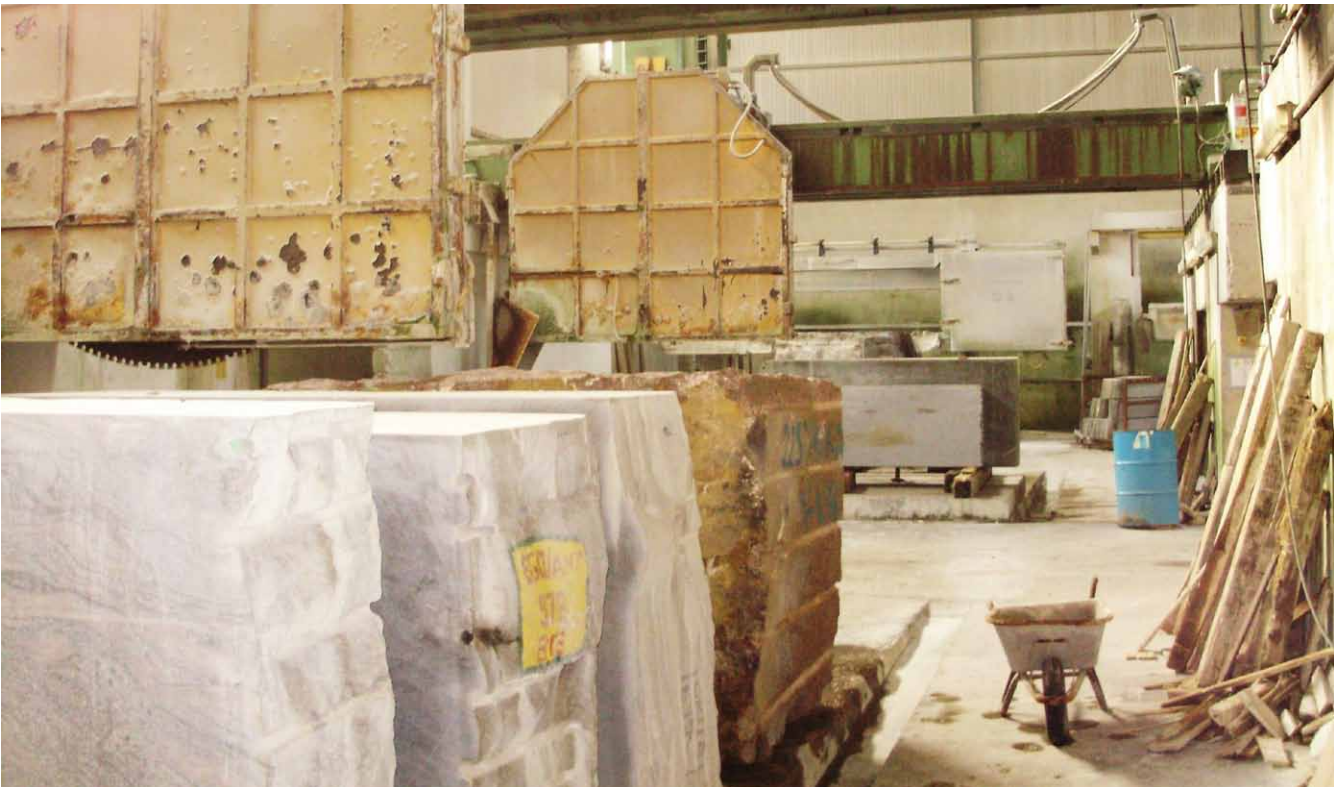
Abb. 14: Halle mit 3 Blocksägen
