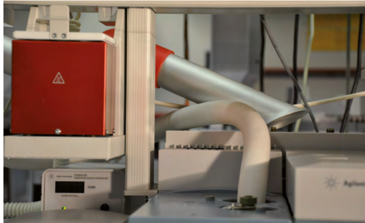
Abbildung 6: Quellenabsaugung an einem Gaschromatographen mit einem beliebig positionierbaren Rohr mit Gelenken
