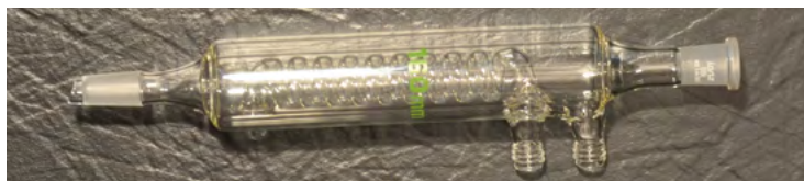
Abbildung 13: Kühler mit Glasgewinden für den Kühlwasseranschluss
