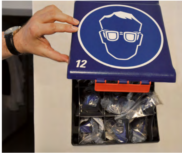
Abbildung 3: Vorratsbox für Besucherschutzbrillen am Eingang zu einem Laborbereich; die Brillen werden nach Gebrauch gereinigt und in Kunststoffbeuteln aufbewahrt
