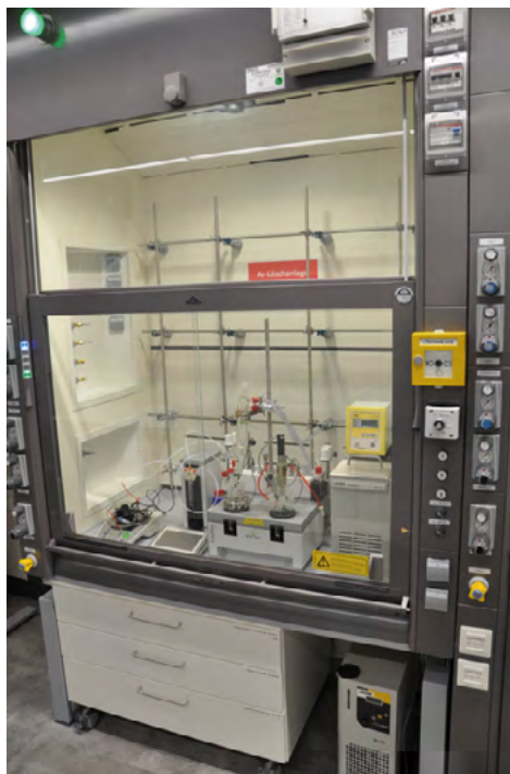
Abbildung 1: Höhenverstellbarer unterfahrbarer Laborabzug. Die Schränke stehen auf Rollen und können nach Bedarf herausgefahren werden, um Platz für eine (im Rollstuhl) sitzende Person zu machen. Wichtige Bedienelemente können auch im Sitzen erreicht werden. Neben der akustischen Alarmierung der Abzugsfunktion ist auch eine doppelte optische Anzeige (in Augenhöhe und oberhalb des Frontschiebers) angebracht. Eine dort arbeitende Person erhält zudem eine jederzeit erreichbare, mobile Einzelarbeitsplatzsicherung mit Alarmtaster.
