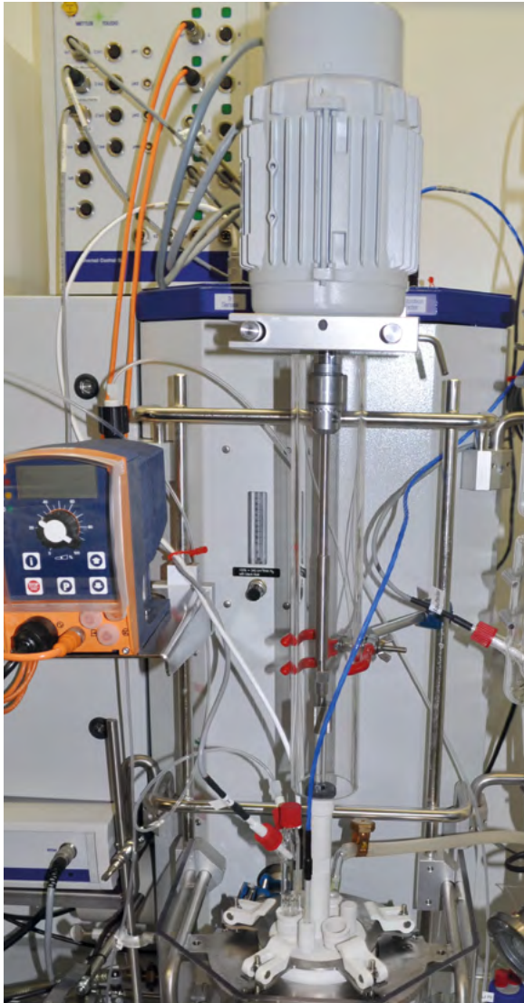
Abbildung 23: Laborrührer mit Schutzhülse aus Kunststoff
