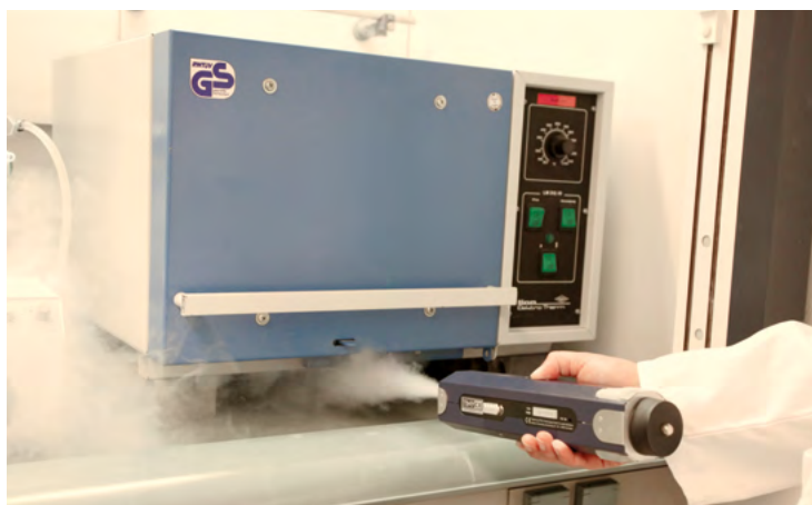
Abbildung 12: Prüfung der Strömungsverhältnisse an einem aufgebockten Ofen im Abzug mit einem handgehaltenen Nebelgenerator
