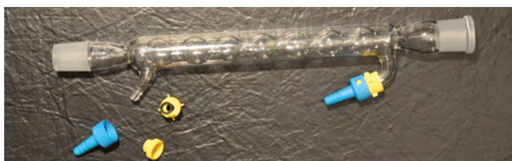
Abbildung 14: Kühler mit Glasoliven für den Kühlwasseranschluss mit Adaptern, die Kunststoff-Schnellkupplungen nachrüsten
