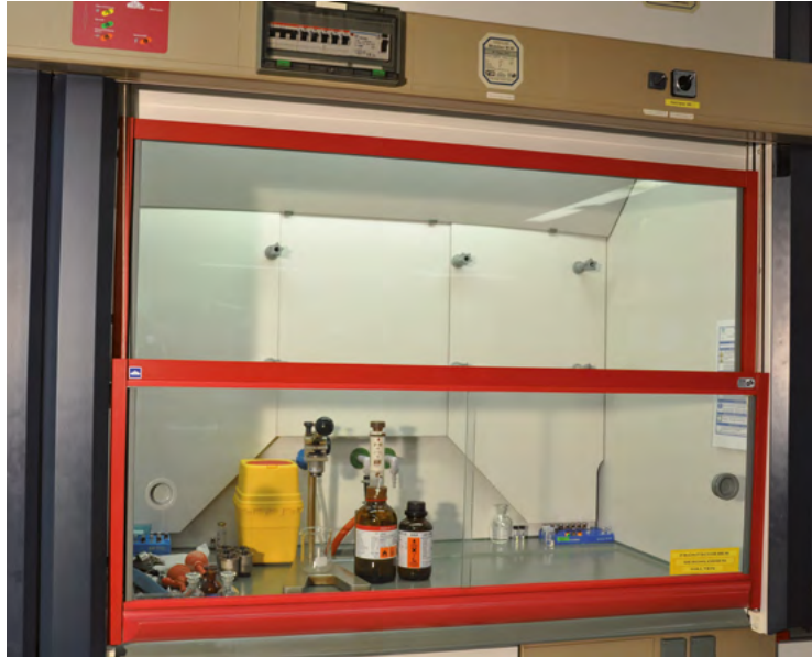
Abbildung 30: Abzug mit geteiltem Frontschieber
