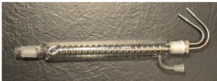
Abbildung 16: Kühler mit eingesetzter Metallkühlspirale
