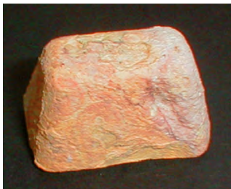
Abbildung 11: Stark oxidiertes Stück Kalium [21]
