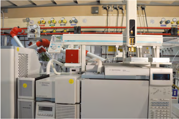
Abbildung 29: Beispiel für eine örtliche Absaugung an einem Gaschromatographen
