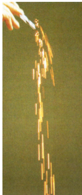
Abbildung 10: Pyrophores Eisen beim Ausschütten aus einer Schutzgas-Ampulle
