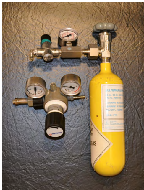
Abbildung 21: Druckminderer und Nadelventil (auf der Flasche)
