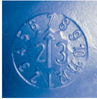
Abbildung 7: „Kunststoffuhr“: Kennzeichnung mit dem Herstellungsdatum (Monat und Jahr)
