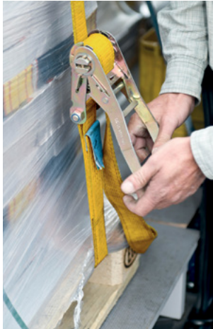
Abbildung 13: Sicherung der Ladung mit einem Zurrgurt
