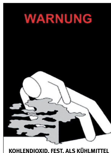
Abbildung 15: Warnkennzeichen bei der Verwendung von Trockeneis als Kühlmittel
