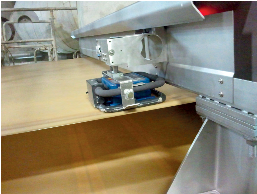
Abbildung 2: Halbautomatische Messeinrichtung mit Standardmessaufnehmer
