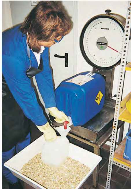
Abbildung 5: Umfüllen von flüssigem Organischen Peroxid unter Nutzung einer Auffangwanne mit inertem Absorptionsmittel
