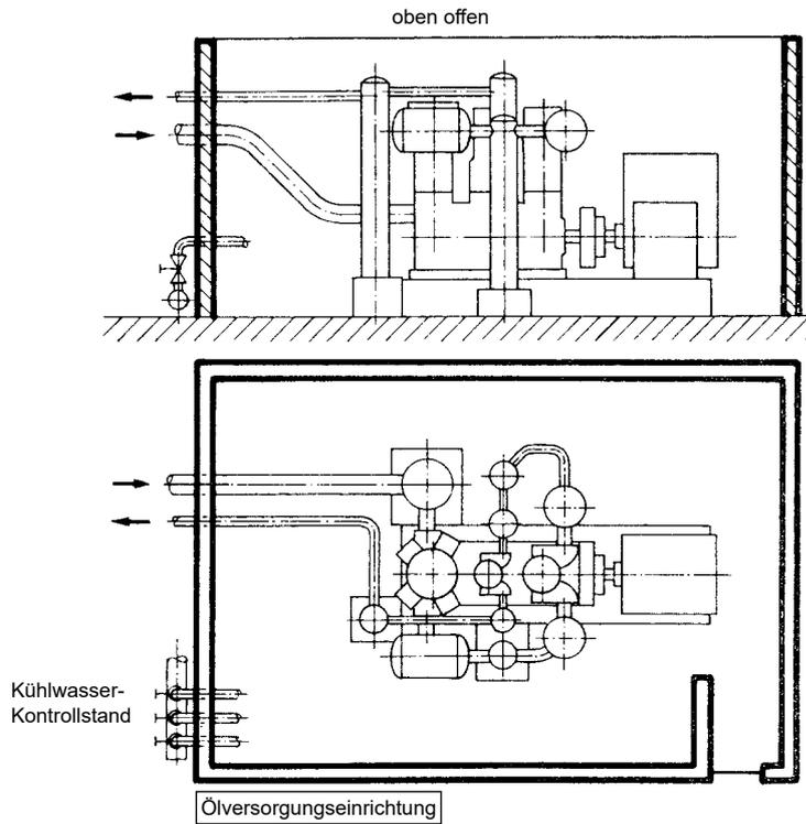
Abbildung 4: Beispiel einer Abschirmung für Sauerstoff-Kolbenverdichter
