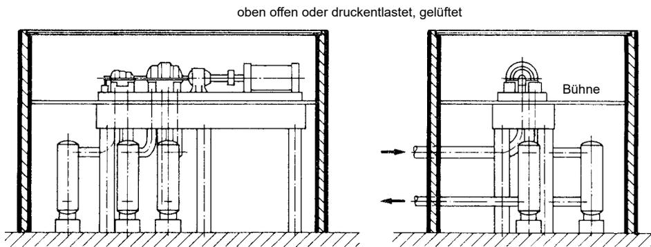
Abbildung 6: Beispiel einer Abschirmung für Sauerstoff-Turboverdichter
