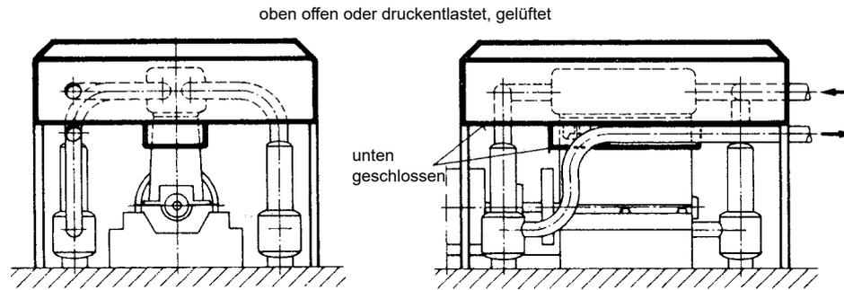
Abbildung 3: Beispiel einer Abschirmung für Sauerstoff-Kolbenverdichter
