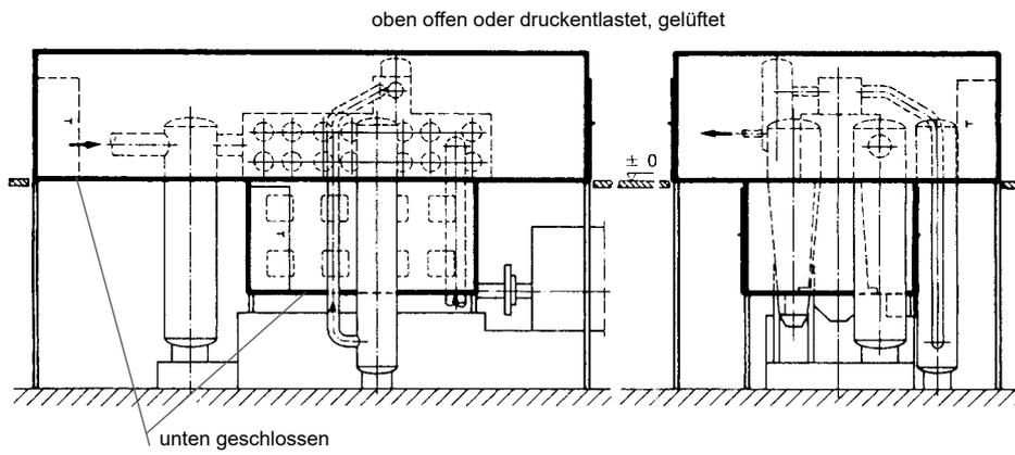
Abbildung 5: Beispiel einer Abschirmung für Sauerstoff-Kolbenverdichter
