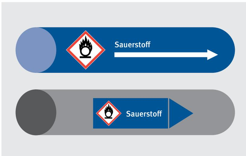
Abbildung 2: Beispiele für die innerbetriebliche Kennzeichnung von Rohrleitungen für Sauerstoff gemäß TRGS 201 und ASR A1.3
