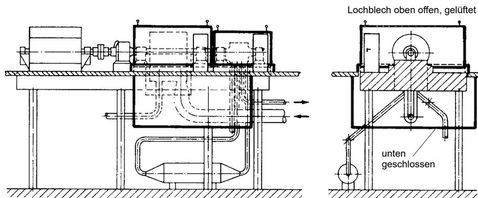
Abbildung 7: Beispiel einer Abschirmung für Sauerstoff-Turboverdichter
