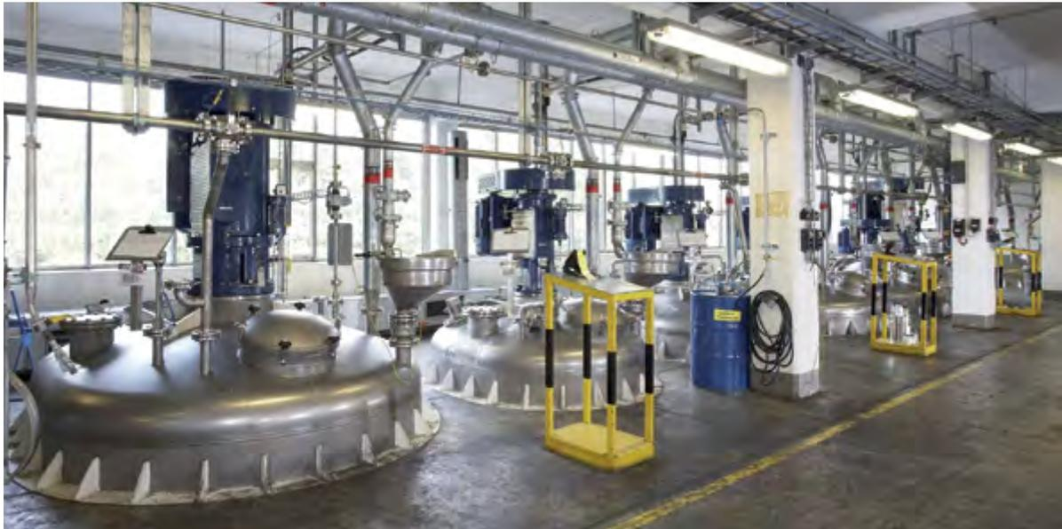
Abbildung 8: Produktionsanlagen mit geschlossenen Rührkesselreaktoren
