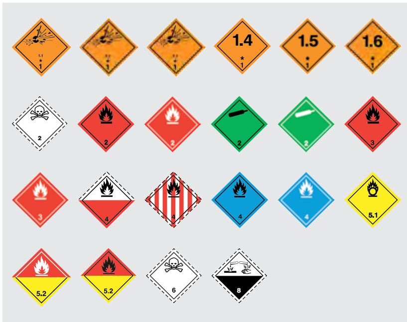
Abbildung 6: Gefahrzettel, die ebenfalls zur Erkennung von Gefahrstoffen dienen können.
