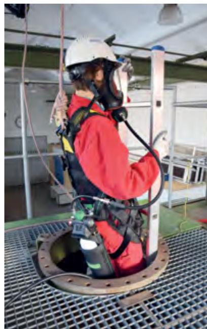
Abbildung 21: Druckluft-Schlauchgerät in Kombination mit einem Pressluftatmer
