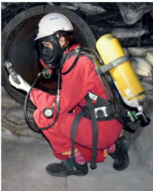
Abbildung 20: Pressluftatmer
