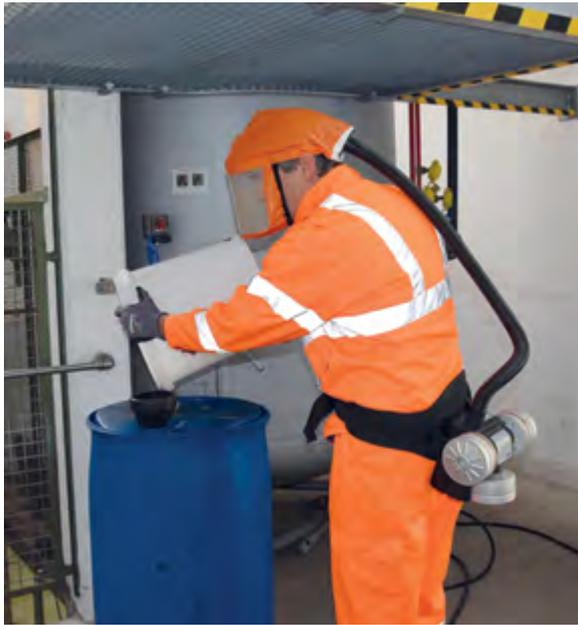
Abbildung 19: Gebläsefiltergerät mit Haube
