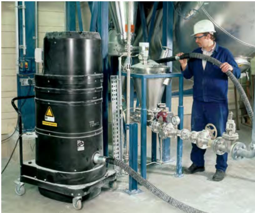
Abbildung 22: Entfernen eines verschütteten pulverförmigen Stoffes mit einem Spezialstaubsauger
