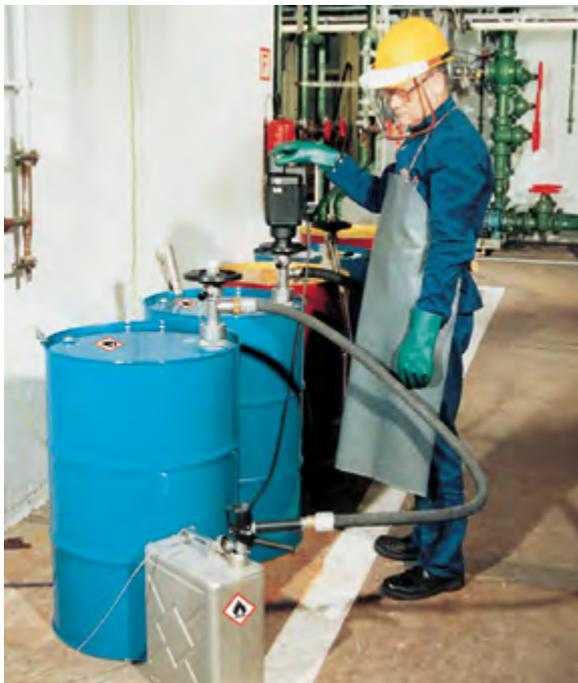
Abbildung 24: Umfüllen einer brennbaren Flüssigkeit
