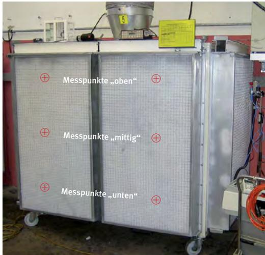
Abbildung 17: Adsorber (Aktivkohlefilter)
