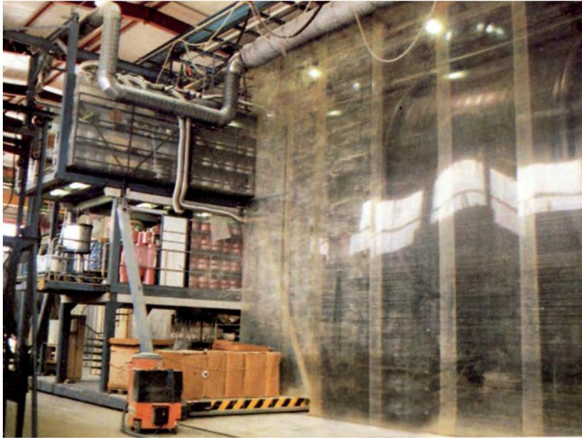
Abbildung 25: Abtrennen des Wickelbereichs mittels Lamellenvorhang
