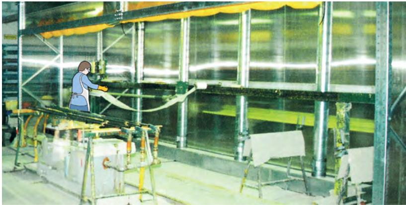
Abbildung 31: Arbeitskabine zur Herstellung dünner Rohre im Wickelverfahren
