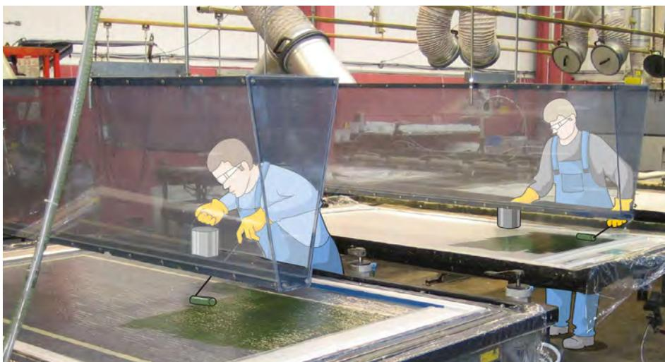
Abbildung 16: Absaughaube/Düsenplatte oberhalb der Formen
