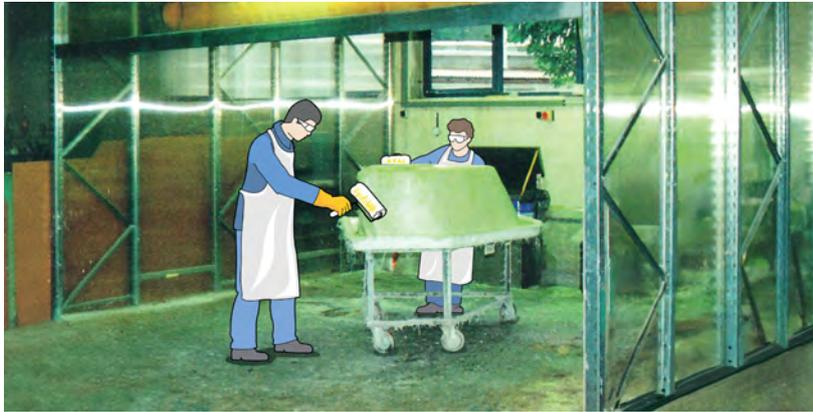
Abbildung 29: Laminierkabine zur Herstellung von Formteilen (hier einer Badewanne)
