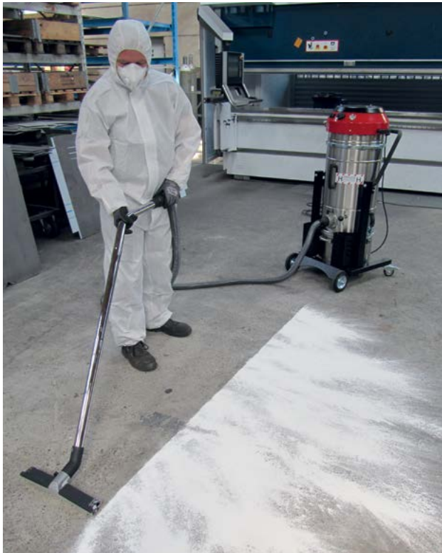
Abbildung 25: Aufsaugen von ausgetretenem Lagergut mit einem explosionsgeschützten Industriestaubsauger
