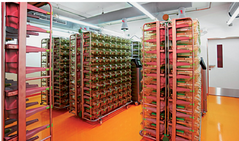
Abbildung 14: Beispiel: Ansicht eines Tierraums mit geschlossenen IVC-Käfigsystemen
