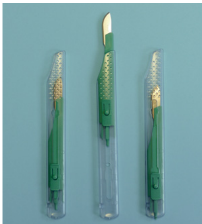
Abbildung 22: Sicherheitskanüle (von links nach rechts: Anlieferungszustand, aufgesteckt auf die Spritze – Arbeitsstellung mit ungeschützter Nadel – Entsorgungsstellung mit arretiertem Nadelschutz)
