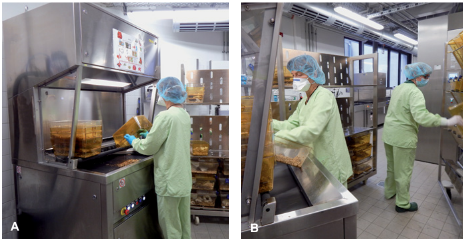
Abbildung 19: A Tätigkeiten an einer Einstreuabwurfstation und B Beladung der Transportwagen für die Reinigungsanlage
