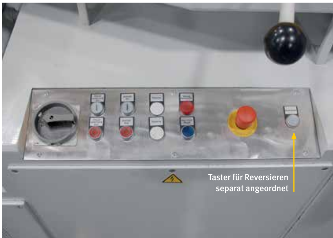
Abbildung 16: Reversieren auf Anforderung nach Not-Halt
