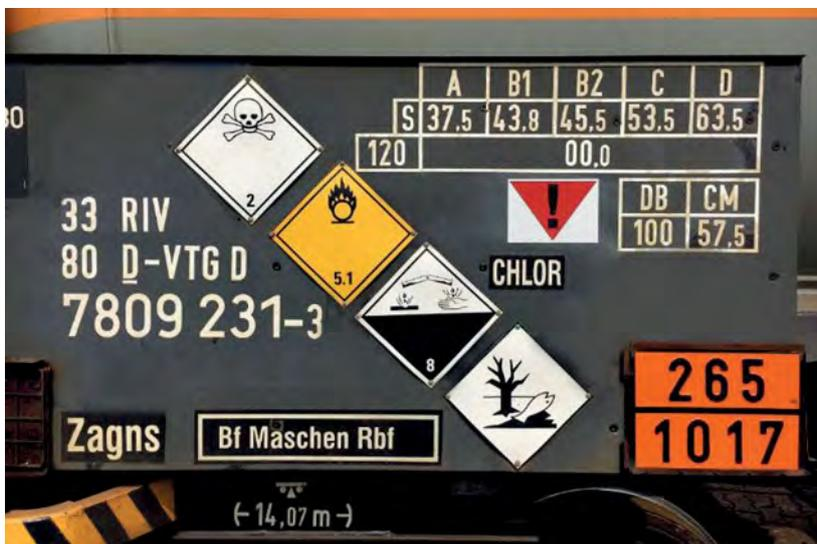
Abbildung 8: Kennzeichnung eines Kesselwagens
