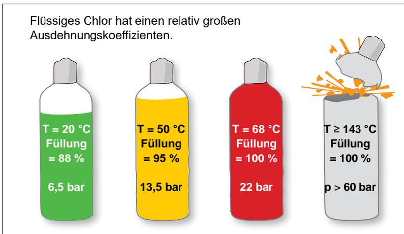
Abbildung 6: Füllungsgrad eines Druckgerätes<sup>2</sup> mit Chlor bei unterschiedlichen Temperaturen
