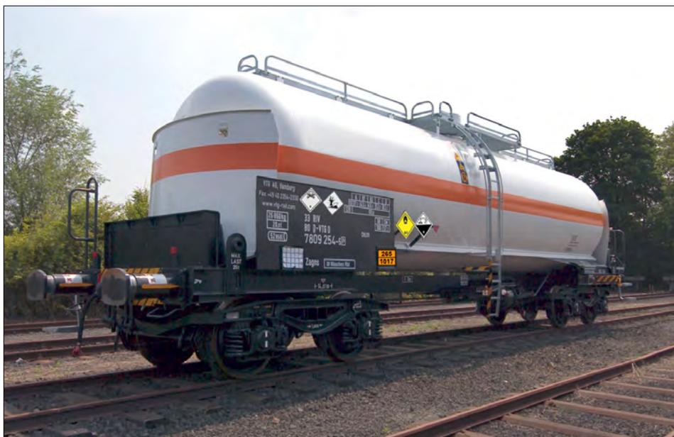
Abbildung 21: Für den Transport von Chlor geeigneter Kesselwagen
