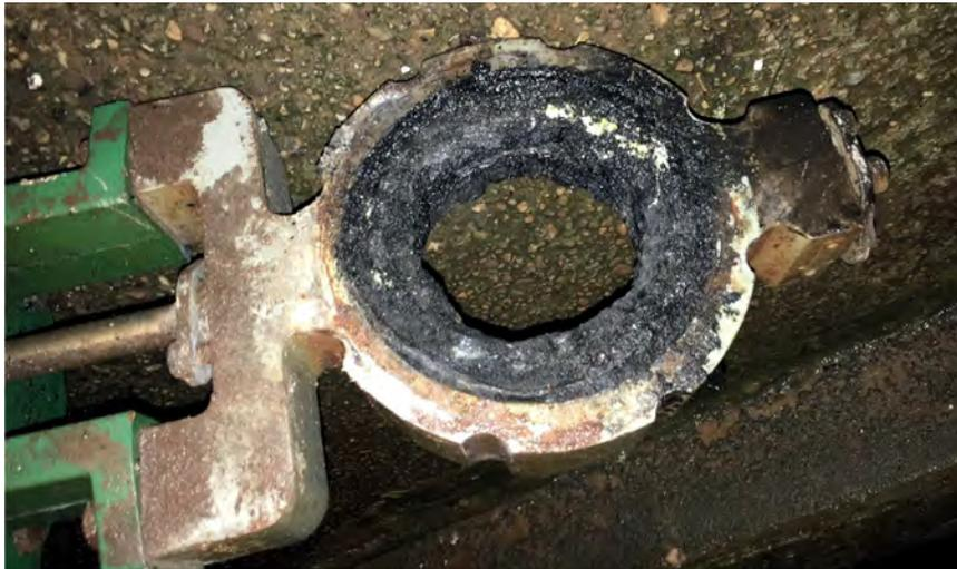
Abbildung 15: Nach Materialverwechslung: Titanventil nach Verwendung in zu trockenem Chlor (unmittelbar)
