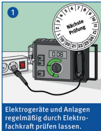
Elektrogeräte und Anlagen regelmäßig durch Elektrofachkraft prüfen lassen.
