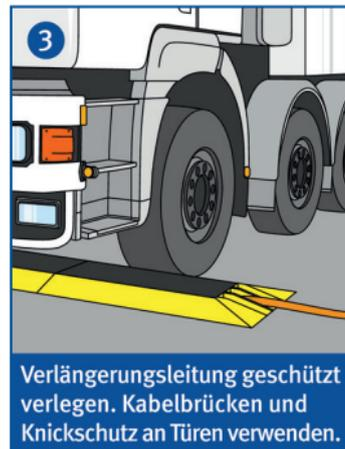
Verlängerungsleitung geschützt verlegen. Kabelbrücken und Knickschutz an Türen verwenden.
