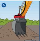
Beim Wechseln von Anbaugeräten korrekte Verriegelung prüfen (Andrucktest).
