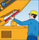
Bei Wartungsarbeiten Knickgelenksicherung/Sicherung gegen Absenken einlegen.
