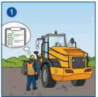
Vor Arbeitsbeginn Erdbaumaschine prüfen (z.B. Spiegel, Scheiben, Reifen, Bremsen).
