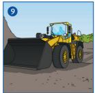
Mit abgesenkter Schaufel fahren (sonst Kippgefahr und Sichteinschränkung).
