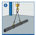
Last so anschlagen, dass sie beim Heben nicht pendelt, schrägzieht oder rausrutscht.
