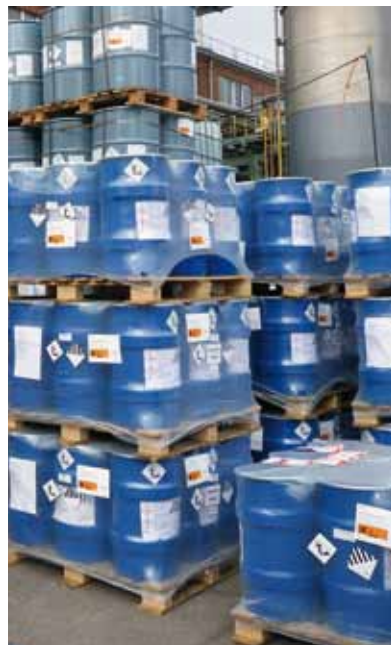
Beim Lagern von Fässern müssen diese in Verbund gebracht werden
