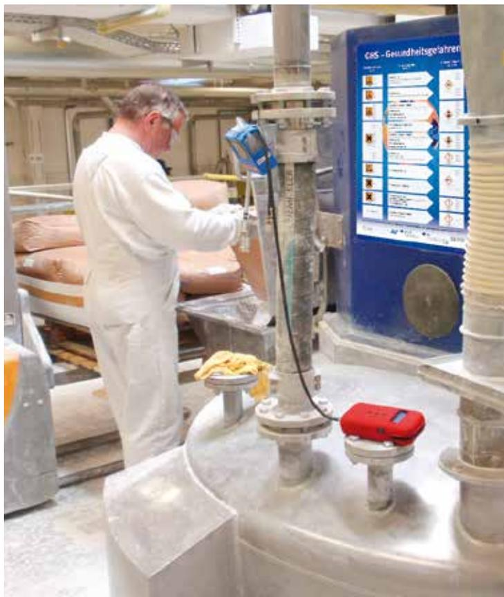
Ortsfeste Staubmessung während eines Befüllvorgangs
