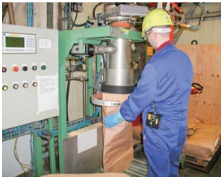
Contrôle d'ambiance par échantillonneur individuel, visant à évaluer l'efficacité d'un système de ventilation
