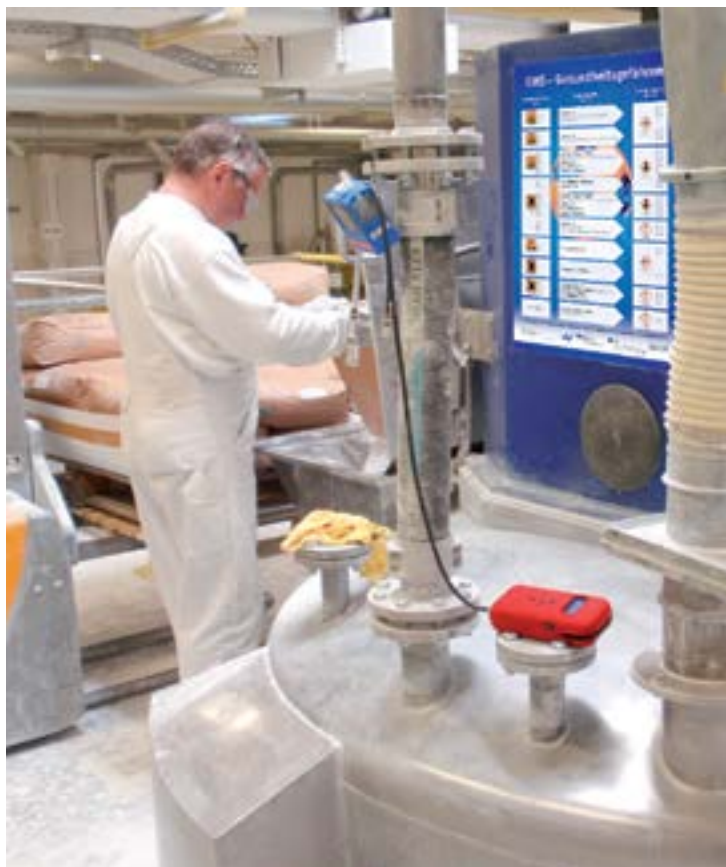
Mesure à poste fixe de l'exposition aux poussières lors d'une opération d'ensachage
