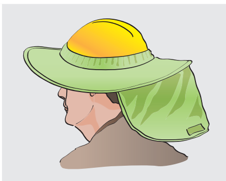
Abbildung 6: Krempe zum Überziehen auf Schutzhelm mit Nackenschutz
