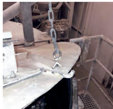
Abbildung 9: Sicherung des Mischerdeckels mittels Kette
