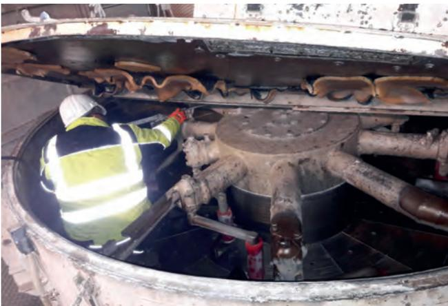
Abbildung 10: Sonderfall, das Reinigen im hinteren Bereich des Tellermischers nur mit Zusatzmaßnahmen
