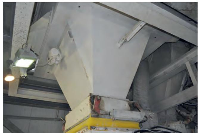
Abbildung 13: Dosiereinheit – Schieber und Klappen der Dosiereinheit müssen sicher geschlossen sein, damit kein Material nachströmen kann
