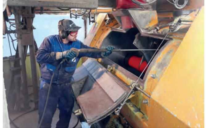
Abbildung 8: Reinigung mit geöffnetem und gesichertem Deckel am Doppelwellenmischer
