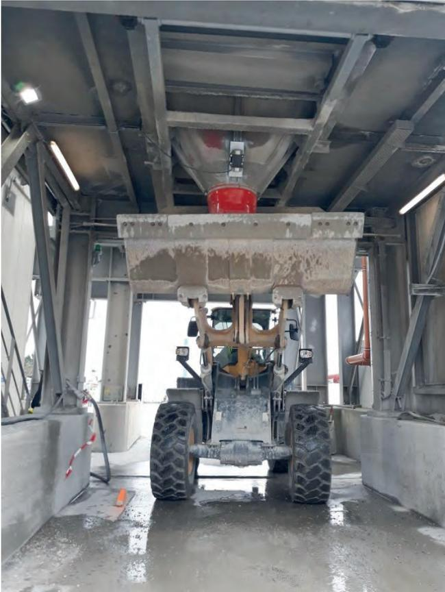
Abbildung 4: Radlader unterhalb des Auslauftrichters zum Auffangen von Betonresten und Reinigungswasser
