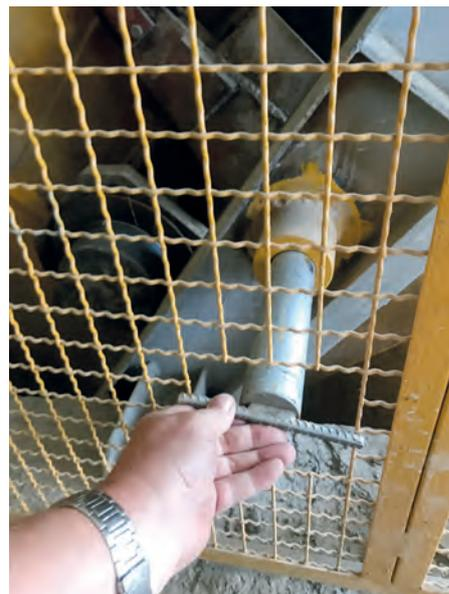
Abbildung 14: Mechanische Verriegelung an der Kübelbahn mittels Bolzen
