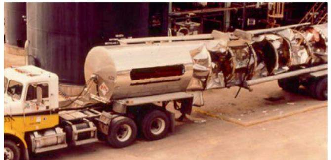
Abbildung 4: Zusammenziehen eines Tanks durch Unterdruck
