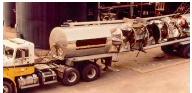
Abbildung 4: Zusammenziehen eines Tanks durch Unterdruck
