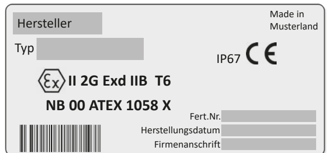
Abbildung 2: Mögliche für den Explosionsschutz relevante Angaben auf dem Typenschild eines explosionsgeschützten Geräts (A) und Beispiel für ein Typenschild (B)
