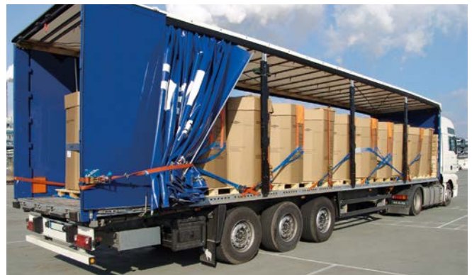
Formschluss hergestellt durch Stirnwand sowie Kopf- und Hecklashing, kombiniert mit Kraftschluss durch Niederzurren
