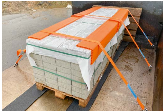
Niederzurren mit Formschluss bei Verwendung von Kantengleitern und Anti-Rutschmatten
