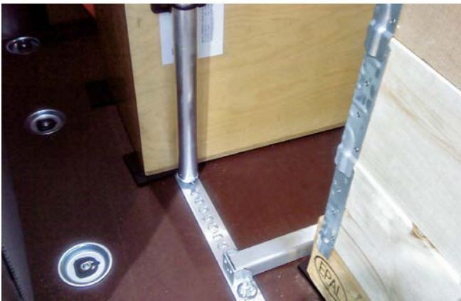
Senkrechte Sperrspange und Sperrbalken
