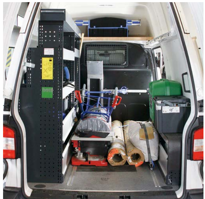
Beispiel für einen nachträglichen Ausbau für Raumausstatter mit ab Werk eingebauter Trennwand
