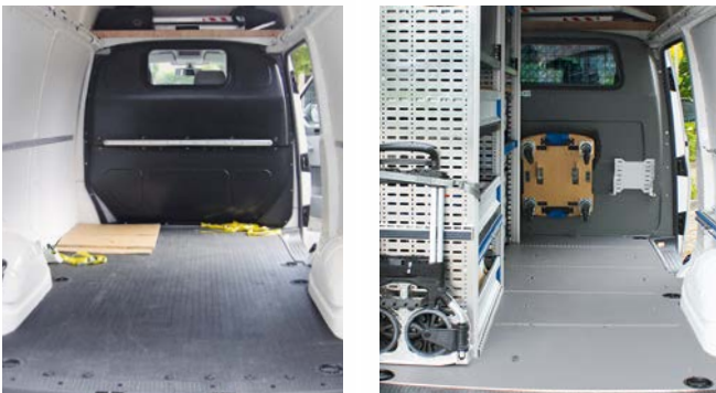
Fahrzeug vor und nach dem Einbau einer Bodenplatte mit Fahrzeugeinrichtung
