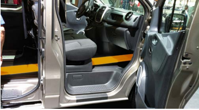
Durchlademöglichkeit durch die Trennwand mit Durchreiche unterhalb des Beifahrersitzes (hier als Beispiel ein Brett)
