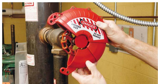
Abbildung 7: Blockier-Einrichtung für Armaturen
