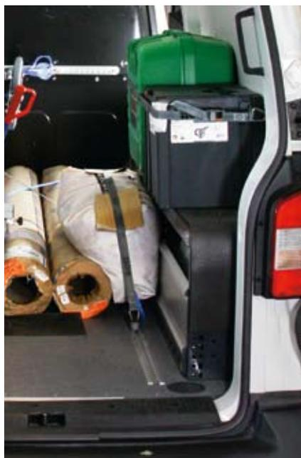
Staufächer und Taschen für Zurrmittel sorgen für Ordnung im Fahrzeug. Im Bild dient ein verbauter Radkasten als Standfläche wie auch als Staufach.
