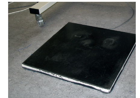
Sensormatte (Fußschalter) mit flacher waagrechtter Trittfläche für Steharbeitsplatz
