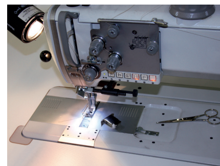
6. Vorhandene Leuchte mit LED-Unterbauleuchte (als Nachrüstsatz) für punktförmige Ausleuchtung der Nähfläche ergänzt
