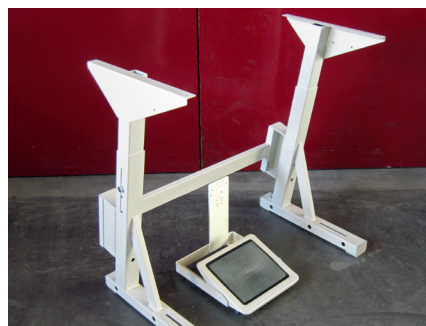
3. Bestehende Traverse durch neue (in abgewinkelter Form und in der Höhe verstellbar – für größeren Beinraum) ersetzt
