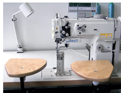
Unterschiedlich höhenverstellbare und flexibel neigbare Armauflagen
