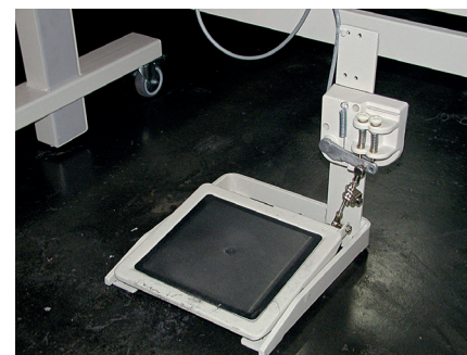
2. Fest montierter Fußschalter wurde durch mobilen Fußschalter (Pedal) ersetzt
