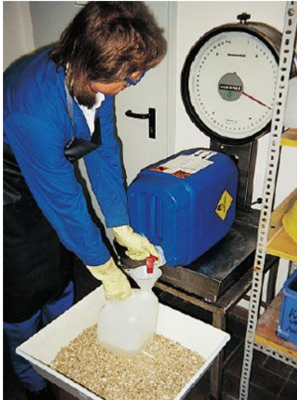
Abbildung 5: Umfüllen von flüssigem Organischen Peroxid unter Nutzung einer Auffangwanne mit inertem Absorptionsmittel
