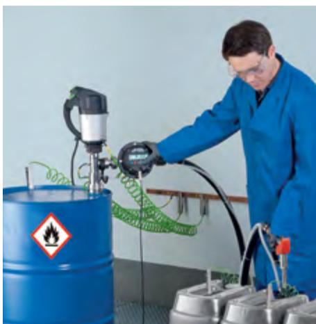
Abbildung 8: Umfüllen mit explosionsgeschützter Pumpe
