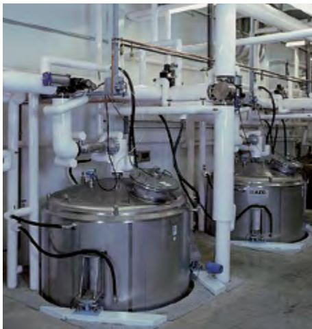
Abbildung 4: Flüssigkeitsvorlagenbehälter zur Verriegelung
