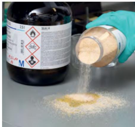
Abbildung 11: Lösemittel mit Bindemittel aufnehmen
