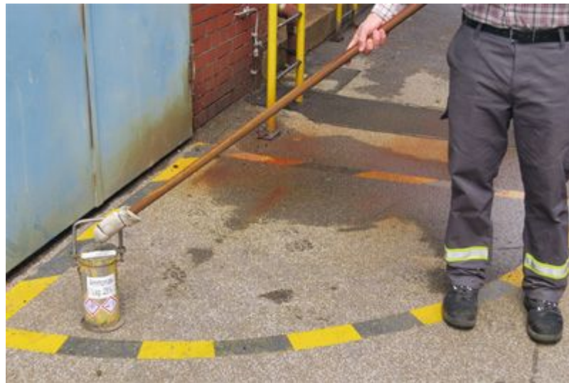
Abbildung 15: Lecksuche mit einem mit Ammoniak getränkten Lappen
