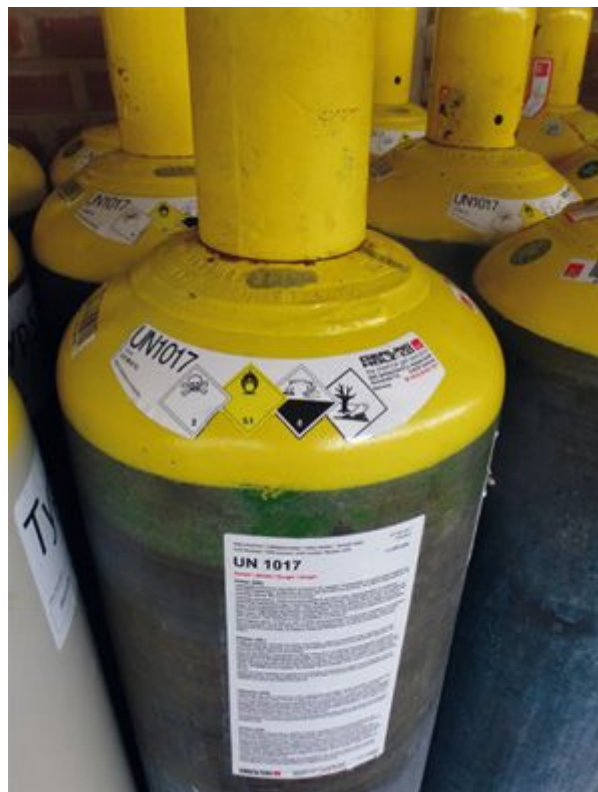
Abbildung 10: Gasflasche für Chlor mit Gefahrzetteln und vollständigem Etikett nach CLP-Verordnung
