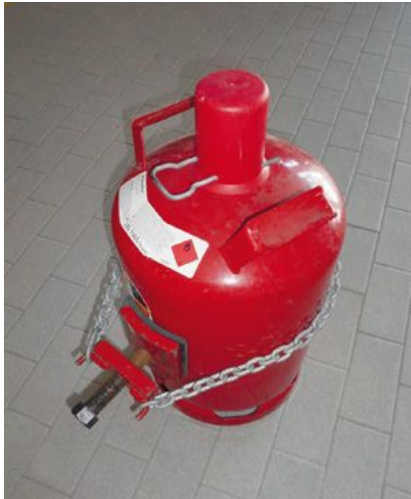
Abbildung 27: Beispiel einer Abdichtung
