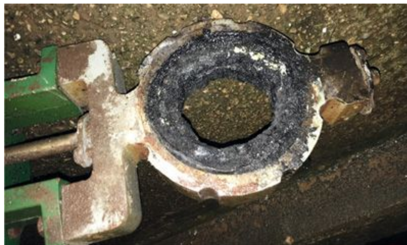
Abbildung 16: Nach Materialverwechslung: Titanventil nach Verwendung im trockenen Chlor (nach kurzer Zeit)
