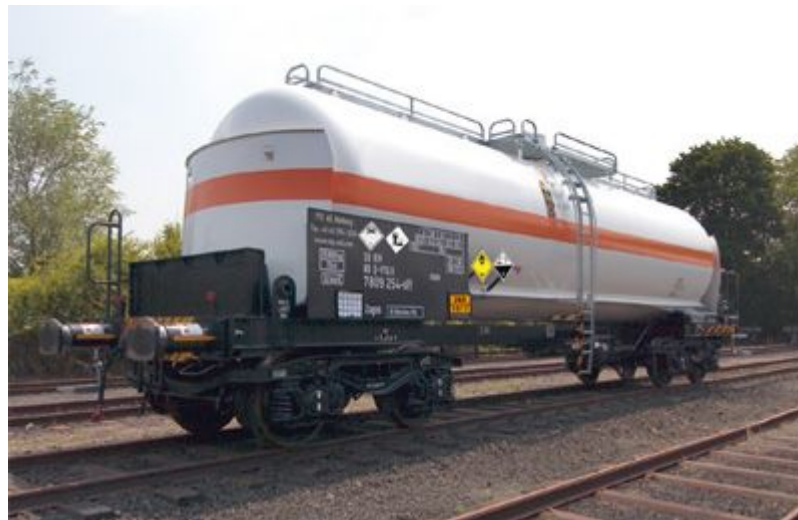
Abbildung 23: Für den Transport von Chlor geeigneter Kesselwagen
