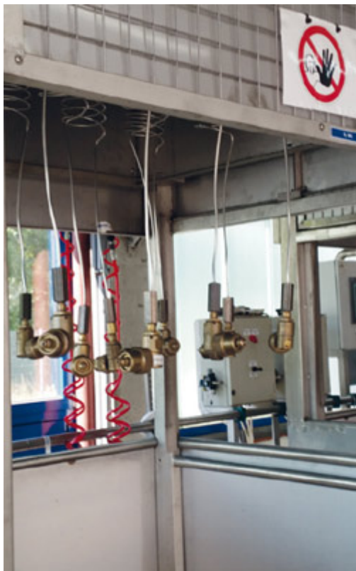
Abbildung 1: Abschirmung eines Füllstandes (links offen, rechts geschlossen)
