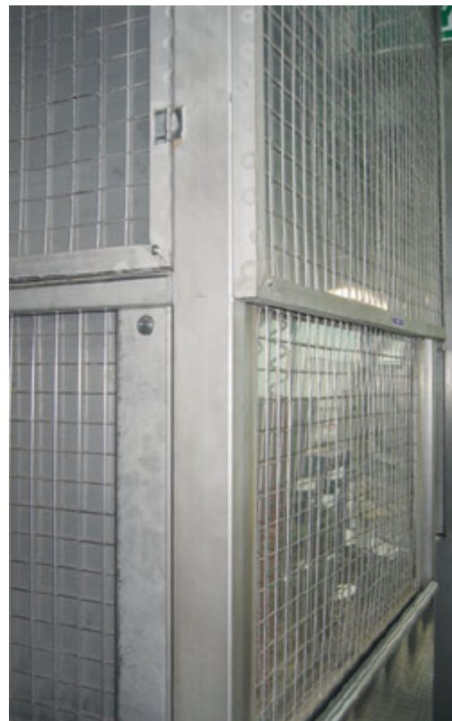
Abbildung 1: Abschirmung eines Füllstandes (links offen, rechts geschlossen)
