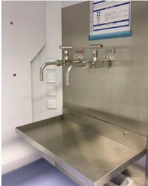
Abbildung 5: Bereitstellung der CKW in einem Sicherheitsschrank neben dem Abzug
