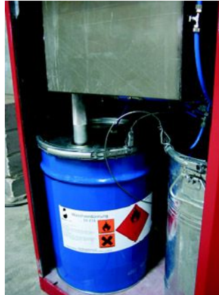
Abb. 10: Geerdetes Fass in einem Reinigungsgerät
