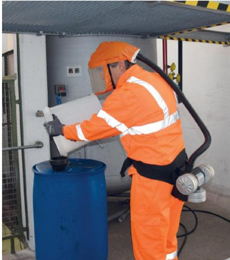
Gebläsefiltergeräte können mit einer Voll-, Halb- oder Viertelmaske, einem Helm oder einer Haube, oder einem Atemschutzanzug als Atemanschluss ausgerüstet sein.
