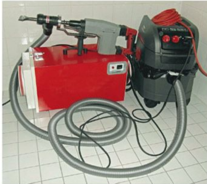
Abbildung 8: Abgesaugte Maschine (hier Abbruchhammer), Bau-Entstauber und Luftreiniger; zusammen mit einer Abschottung sind die Basisausrüstung staubarmer Techniken für jeden Betrieb
