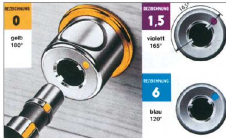
Abbildung 7: Nicht vertauschbare Anschlüsse
