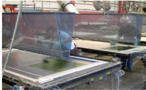
Die bestehende RLT-Anlage wird mit einem erheblich reduzierten Zu- bzw. Abluftvolumenstrom von jeweils 12 000 m<sup>3</sup>/h weiterbetrieben.
