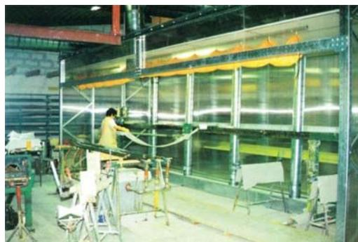
In der Arbeitskabinen werden Metallrohre mit Glasfasermatten umwickelt und styrolhaltiges Harz wird manuell aufgetragen. Durch die neue Arbeitskabinen wurde die Styrolbelastung des Mitarbeiters von 270 mg/m<sup>3</sup> auf 30 mg/m<sup>3</sup> reduziert.
