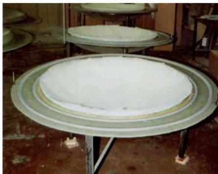
Das offene Handlaminiere bei der Herstellung von Klöpperböden mit relativ hohen Styrolemissionen wurde durch den Einsatz von verschließ- und evakuierbaren Formen überflüssig gemacht.
