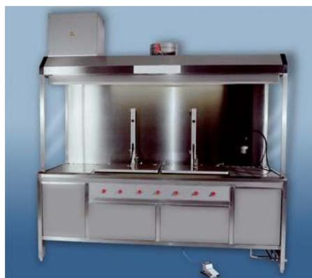
In der abgebildeten Anlage werden verunreinigte Werkzeuge und Arbeitsmittel mit Aceton gereinigt. Durch die gezielte Luftzuführung und die Absaugung im Wandbereich werden die Lösemitteldämpfe von den Beschäftigten weggeführt. Diese Anlage entspricht den Anforderungen der BG-Regel „Richtlinien für Einrichtungen zum Reinigen von Werkstücken mit Lösemitteln“ (BGR 180).
