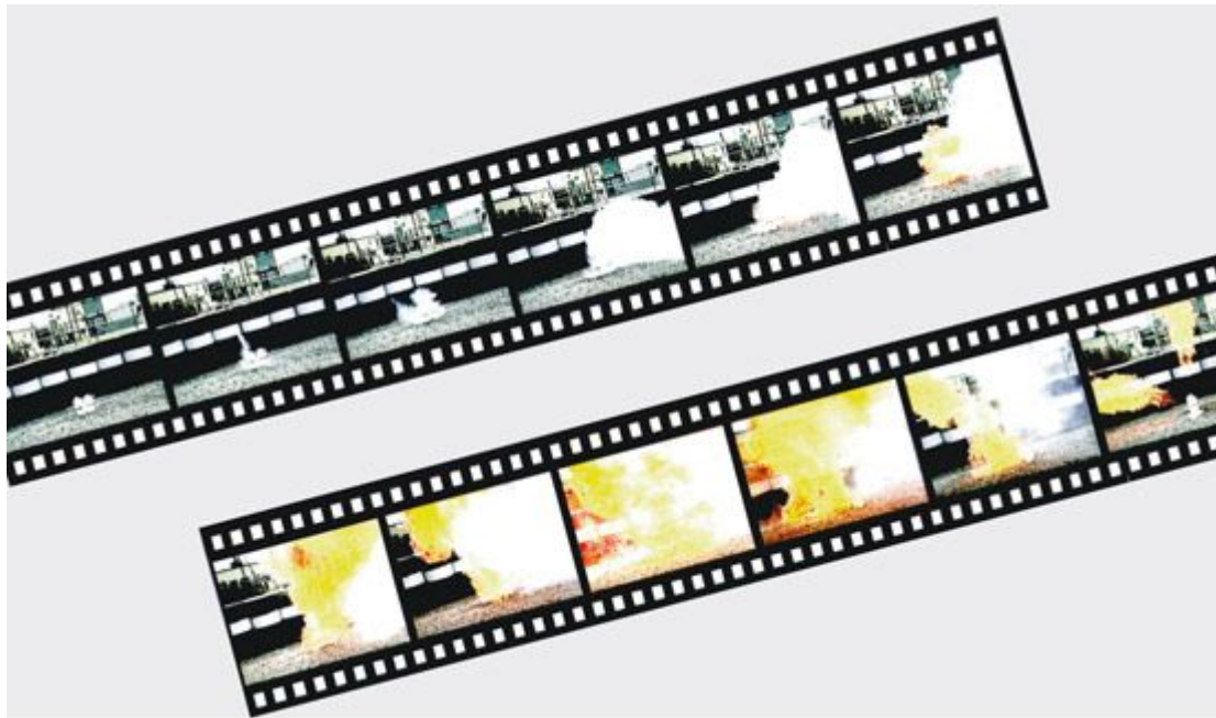
Abbildung 6: Zeitrasterdarstellung eines Demonstrationsversuchs zum unsachgemäßen Lagern oder Abstellen von Organischen Peroxiden
