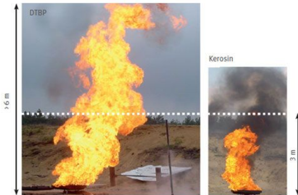
Abbildung 7: Vergleich des Abbrandverhaltens gleicher Mengen von Di-tertiär-Butylperoxid (DTBP) und Kerosin
