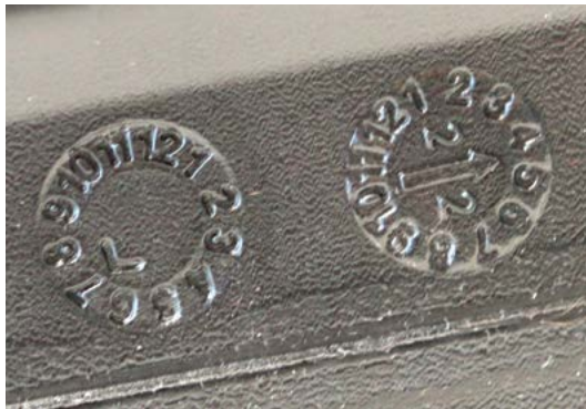
Abbildung 5: „Kunststoffuhr“ auf dem Boden eines Kraftstoffkanisters
