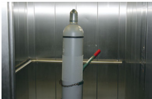
Abbildung 4: Transport von Druckgasflaschen in einem Aufzug
