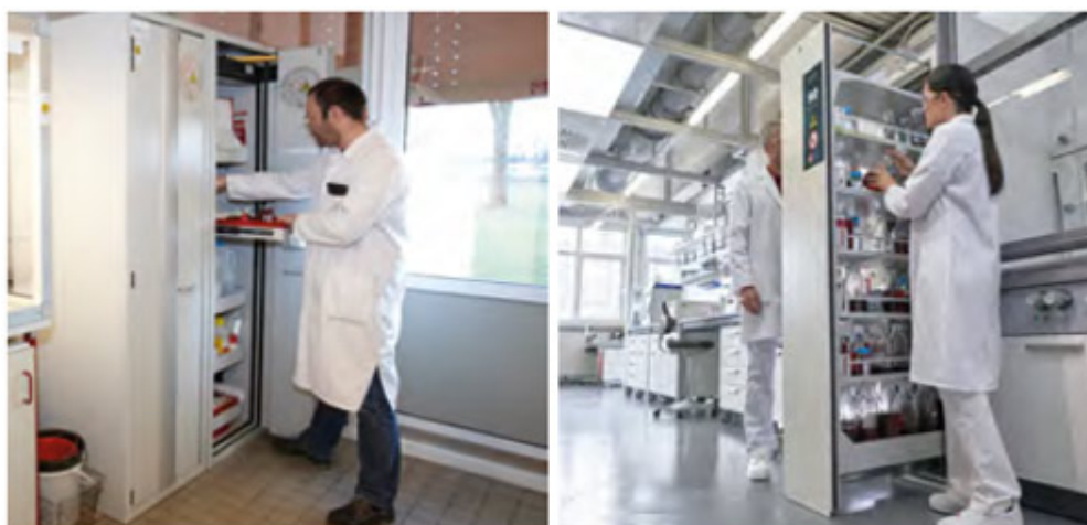
Abbildung 7: Sicherheitsschränke für brennbare Flüssigkeiten nach DIN EN 14470-1
