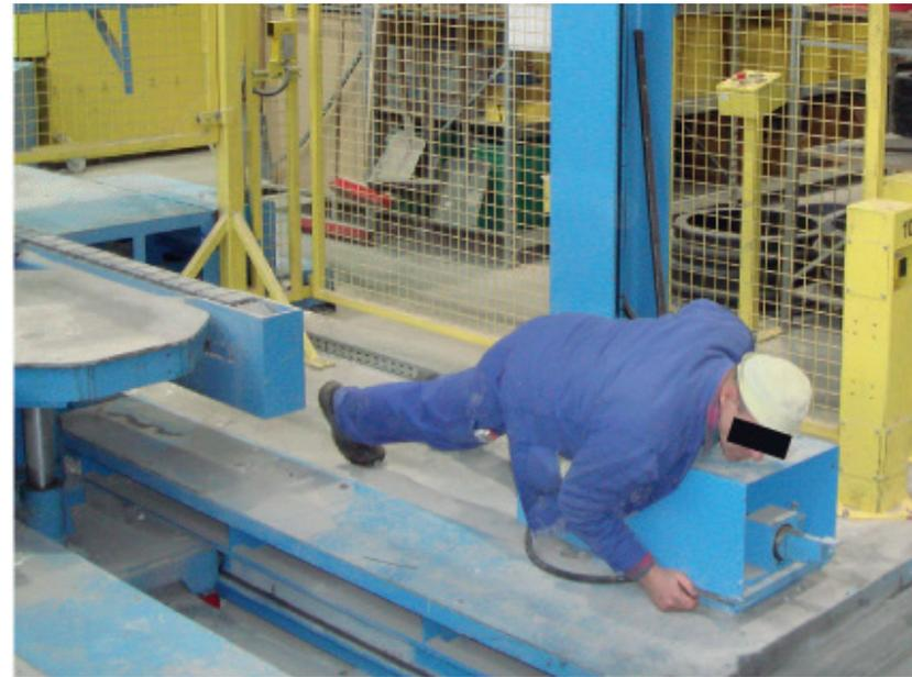
▲ Zwecks Fehlersuche legte der Mitarbeiter sich bäuchlings auf eine Schutzabdeckung. Dabei war er so in seine Detektiv-Arbeit vertieft, dass er nicht merkte, wie ein Greifer über ihn schwenkte und langsam mit vollem Druck auf ihn niederfuhr.
