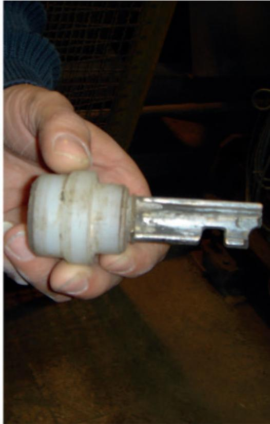
▲ *Selbstgebaut – dieser Kunststoffgriff mit Bart wurde als Dietrich benutzt, um den Sicherheitsschalter zur Tür einer Plattenpresse kurzzuschließen.*
