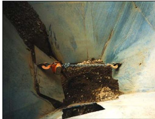
▲ *Als der Mitarbeiter diese Spannvorrichtung einbaute, kippte sein Kollege nichtsahnend eine volle Ladung Steinmaterial ins Silo. Der Mitarbeiter wurde verschüttet und starb.*
