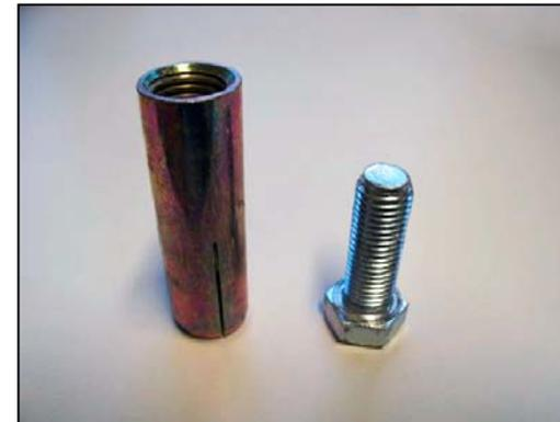
▲ **Die verwendeten vier Schlagdübel** waren nicht fachgerecht eingesetzt. Sie waren nicht in der vorgesehenen Endposition fixiert und konnten somit auch nicht die maximale Zugkraft aufnehmen.
