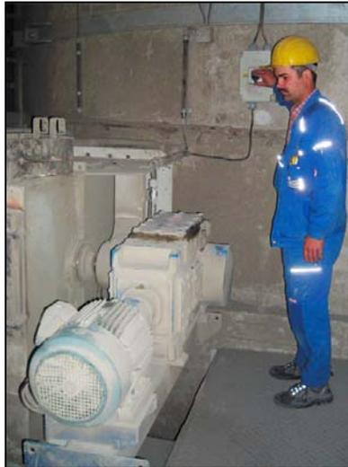
▲ **Nachgestellt:** Um die Blockade an einem Zementaustrag zu lösen, polte ein Mitarbeiter den Antriebsmotor unerlaubt auf „Rückwärtsgang“. Die Kraft, die nach etlichen Wiederholungen auf die Antriebswelle wirkte, riss die Drehmomentstütze aus dem Betonfundament.
