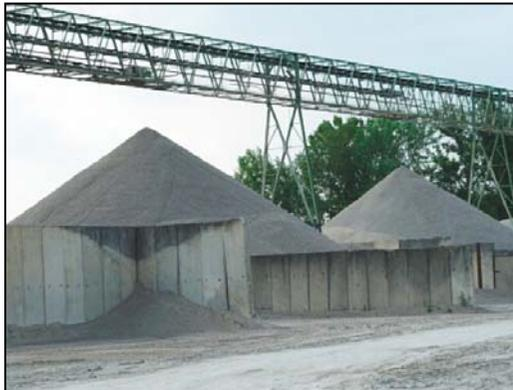
◀ Die Materialhalden des Kieswerks. Hier hielt sich der Betriebsleiter mit seinen Kollegen im Gefahrenbereich des Abzugstrichters auf. Die Entnahmeeinrichtung lief. Als der Kies sich in Bewegung setzte, geriet der Betriebsleiter in den Materialsog.
