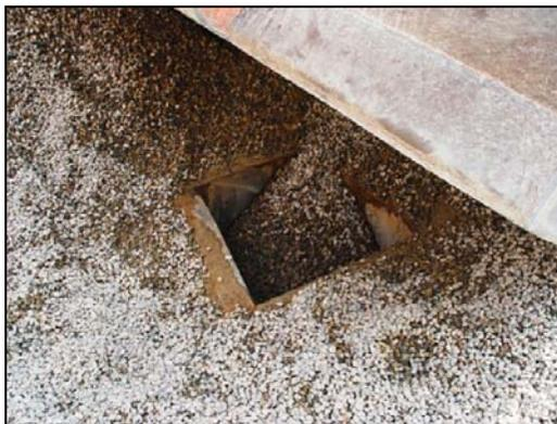
◀ Öffnung des Abzugsschachtes, über den der Kies auf ein Förderband in einen Tunnel unterhalb der Halde abgezogen wird. In diesen Trichter wurde der Betriebsleiter eingezogen.
