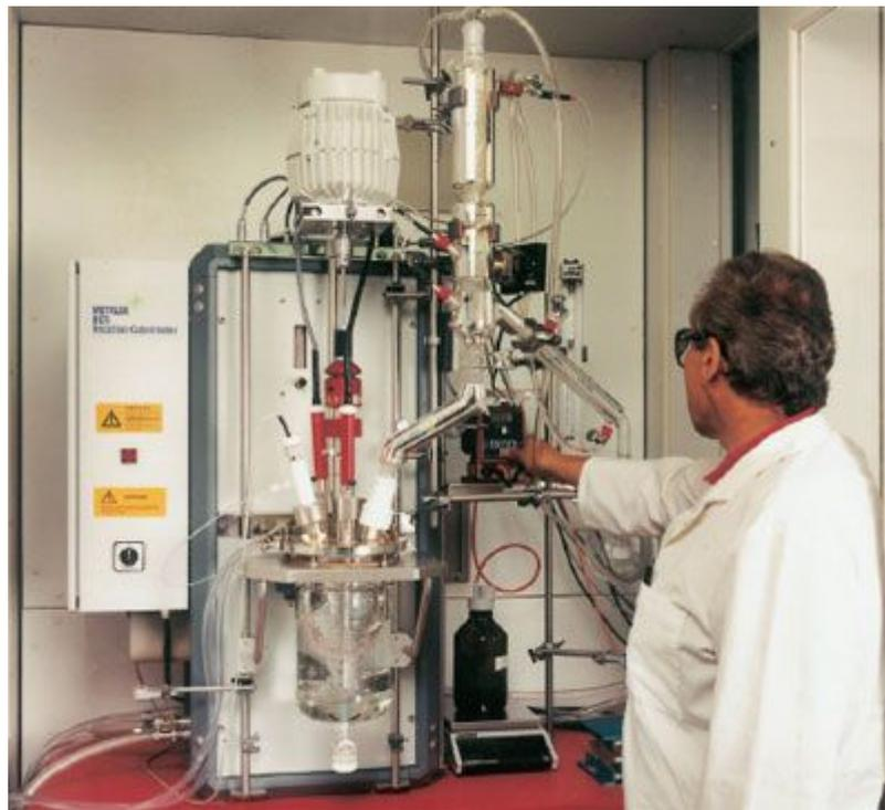
Entstehen bei der Reaktion gasförmige Produkte, so ist auf deren gefahrlose Ableitung zu achten.
